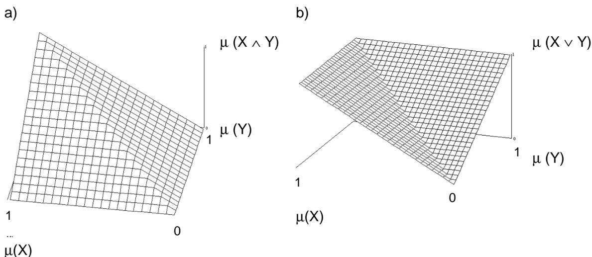
Abbildung 46: Nicht-kompensatorische min-max-Operatoren. Zur Abbildung der UND-Verknüpfung wird das Minimum (a), für das logische ODER das Maximum (b) verwendet.
