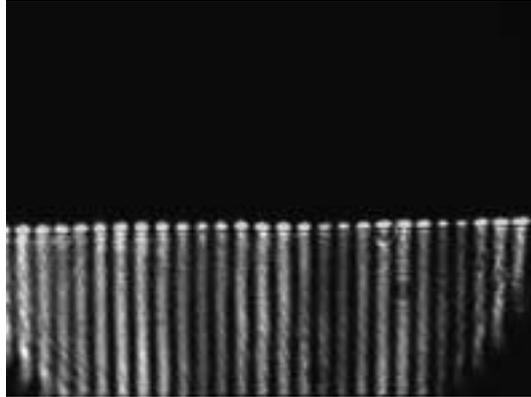
**Abbildung 3.2:** Streubild, aufgenommen mit einer CCD-Kamera in einem Winkelbereich um die  $90^\circ$ -Richtung.  $\lambda = 683$  nm, parallel polarisiert, Tropfen aus  $MgCl_2$ -Lösung, Durchmesser ca.  $40 \mu\text{m}$ .
