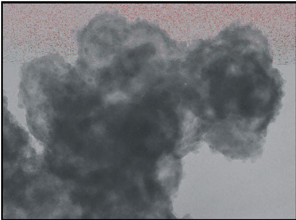
*Abb.25: TEM-Aufnahme von kolloidalen Partikeln in einer Schicht. Reaktionszeit 20 min und Reaktionstemperatur 60 °C. Zusammensetzung der Lösung:  $[Zn(CH_3CO_2)_2]=0.01\text{mol/l}$ ,  $[SC(NH_2)_2]=0.01\text{mol/l}$ ,  $[NH_3]=1\text{mol/l}$  und  $[N_2H_4]=1\text{mol/l}$ .*
