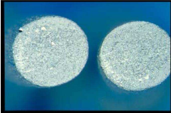
**Abb. 12: Bruchfläche der Probe 6, bester Wert der Serie 4 Neumaterial gelötet, korrodiert**
