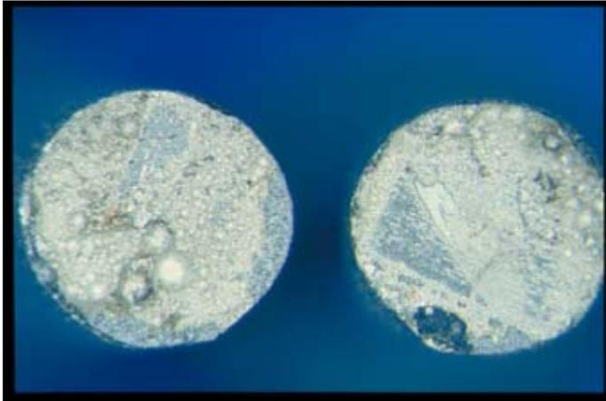
**Abb. 14: Bruchfläche der Probe 8, schlechtesten Wert der Serie 4 Neumaterial gelötet, korrodiert**
