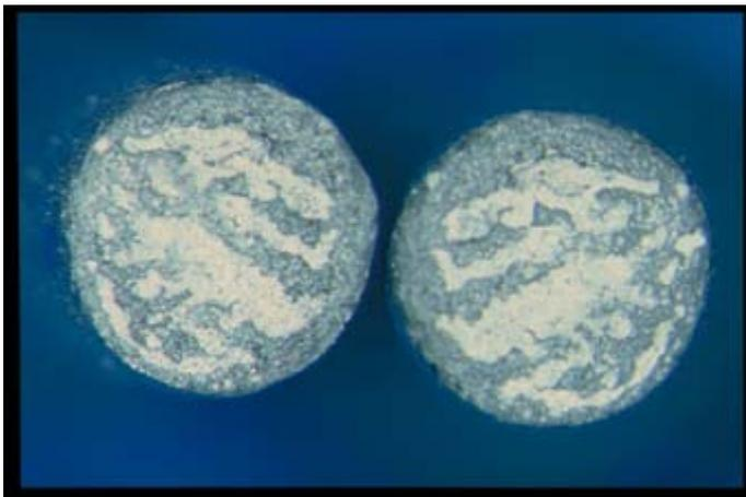
**Abb. 9: Bruchfläche der Probe 5, bester Wert der Serie 3 Neumaterial gelötet, nicht korrodiert**
