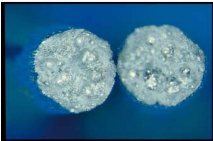
**Abb. 27: Bruchfläche der Probe 1, besten Wert der Serie 9 Neumaterial gelasert mit Zulegematerial, nicht korrodiert**
