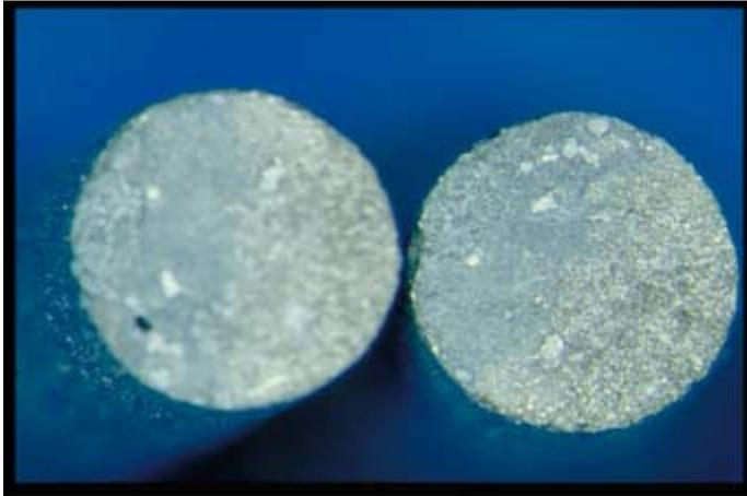
**Abb. 10: Bruchfläche der Probe 4, medianer Wert der Serie 3 Neumaterial gelötet, nicht korrodiert**
