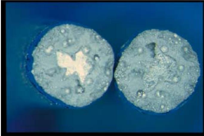
**Abb. 24: Bruchfläche der Probe 7, bester Wert der Serie 8 Altmaterial gelasert stumpf, korrodiert**
