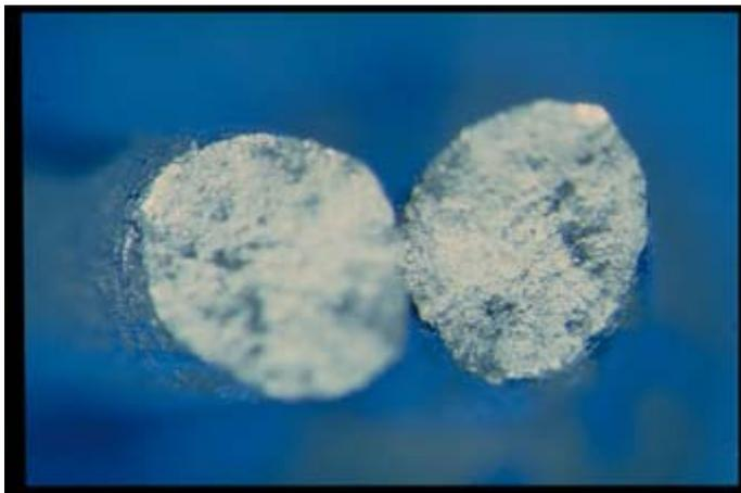
Abb. 7: Bruchfläche der Probe Serie 1 Neumaterial ungefügt, nicht korrodiert
