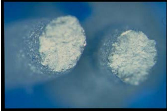
**Abb. 8: Bruchfläche der Probe Serie 2 Altmaterial ungefügt, nicht korrodiert**
