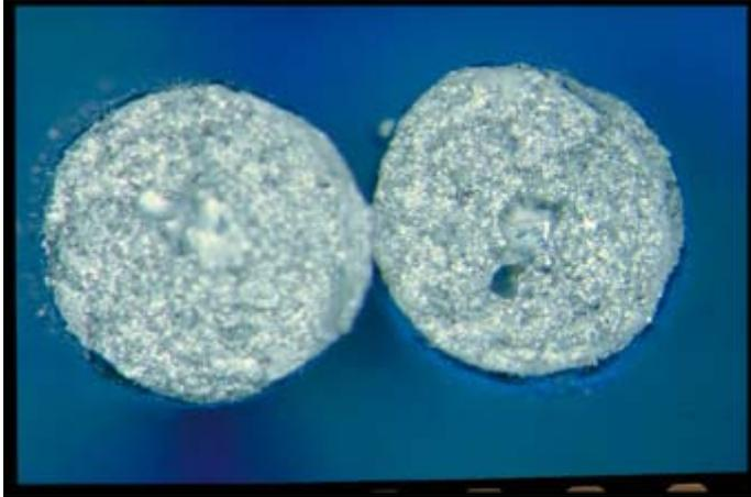
**Abb. 20: Bruchfläche der Probe 1, schlechtesten Wert der Serie 6 Neumaterial gelasert stumpf, korrodiert**
