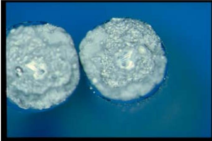
**Abb. 18: Bruchfläche der Probe 6, bester Wert der Serie 6 Neumaterial gelasert stumpf, korrodiert**
