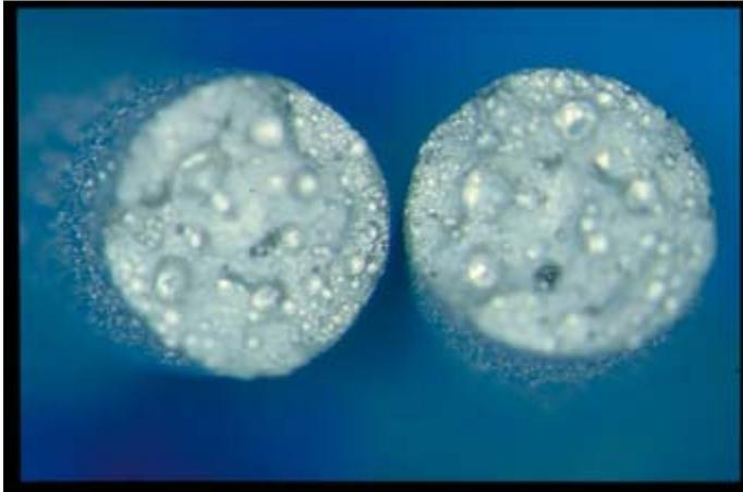
**Abb. 30: Bruchfläche der Probe 7, bester Wert der Serie 10 Neumaterial gelasert mit Zulegematerial, korrodiert**
