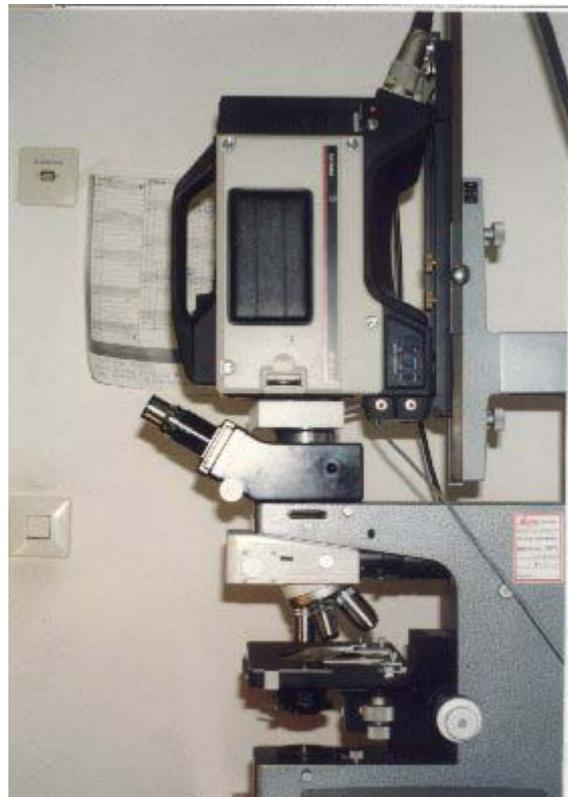
Abb.15: Das im Lichtmikroskop sichtbare Bild wird direkt von einer Videokamera aufgenommen (Philipps-3 Kanal-Farb-Videokamera)
