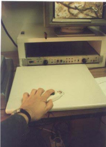
Abb. 17: Eine Digitalisierplatte mit entsprechender Maus erlaubt dem Untersucher die genaue Markierung der Interessenbereiche des Videobildes.
