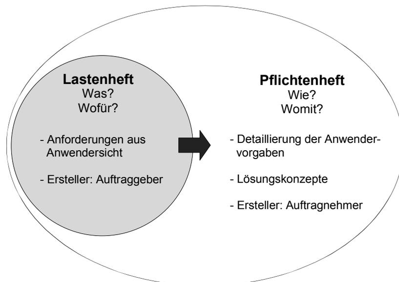
**Bild B1:** Abgrenzung zwischen Lasten- und Pflichtenheft gemäß der VDI/VDE-Richtlinie 3694 /VDIE 3694/
