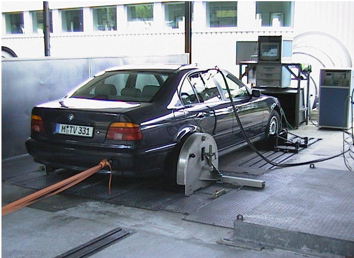
Bild A 3.1: Versuchsfahrzeug (BMW 528i) in meßfertigem Zustand auf Rollenprüfstand (Fa. Schenk)
