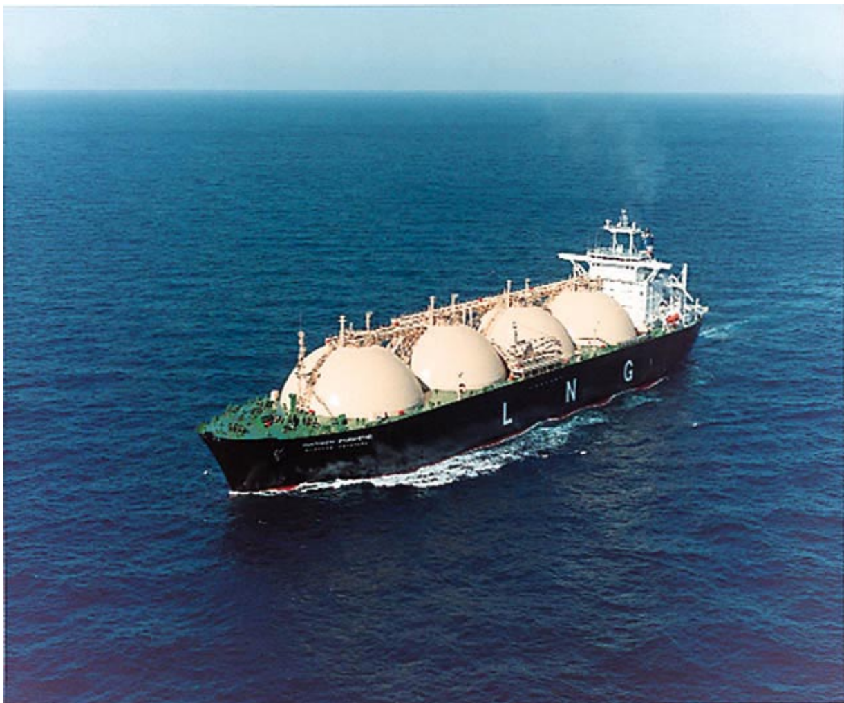
Bild A 5.2: 125 000 m 3 LNG-Hochseetanker mit kugelförmigen Kvaerner Moss Tanks [GABI 99/2]
