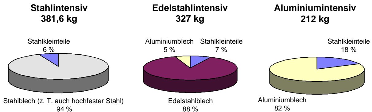
Bild 6.2: Gewichtsanalyse der Karosseriestrukturen (Rohkarosseriegewichte)
