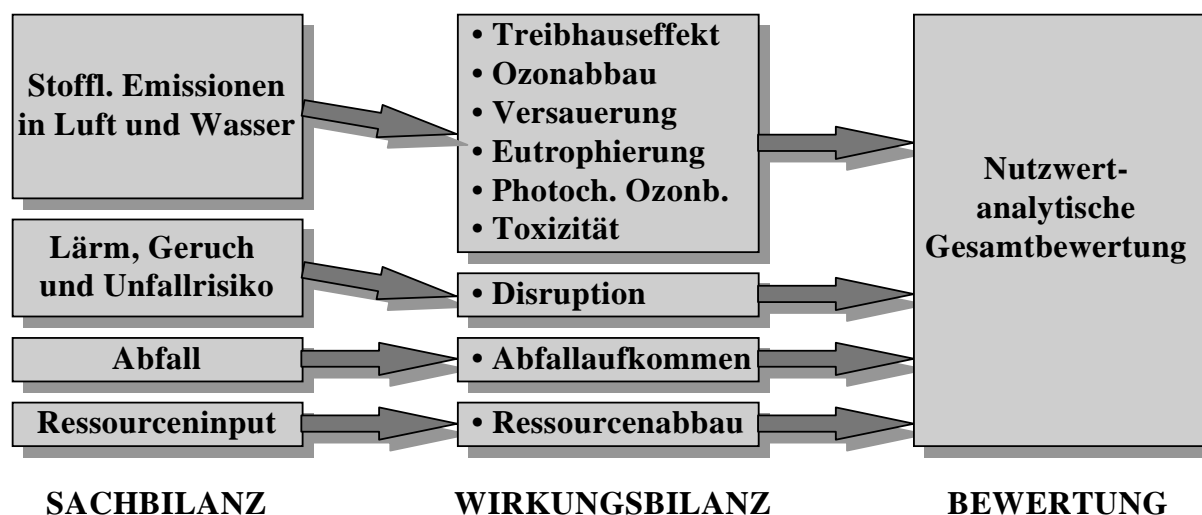
Bild A 1.4: Bilanzierungsschema des Integrated Substance Chain Management (nach [ANNEMA 92])
