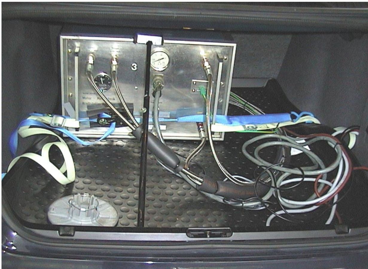
Bild A 3.3: Durchflußmeßgerät PLU 116H zur Ermittlung des Kraftstoffverbrauchs (eingebaut im Kofferraum des Versuchsfahrzeuges)
