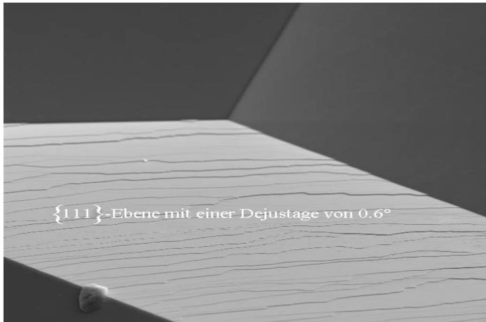
**Abb. 3.12:** Freigeätzte {111}-Ebene mit einer Dejustage der Maske von  $0,6^\circ$ . Geätzt wurde n-Silizium bei  $80^\circ\text{C}$  für drei Stunden in 30%iger RdH-KOH. Der spezifische elektrische Widerstand der Siliziumwafer betrug 5-10 Ocm.
