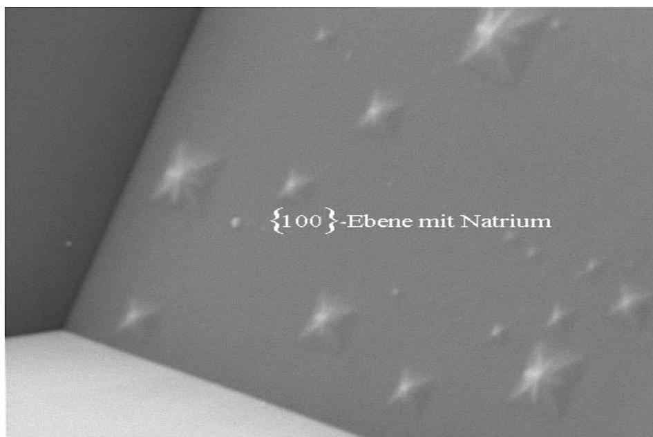
**Abb.3.9:** REM-Aufnahme der {100}-Ebene mit Natrium. Geätzt wurden präzisionsorientierte n-Siliciumproben bei 80°C für drei Stunden in 30%iger RdH-KOH. Der spezifische elektrische Widerstand der Siliciumwafer betrug 5-10 Ocm.
