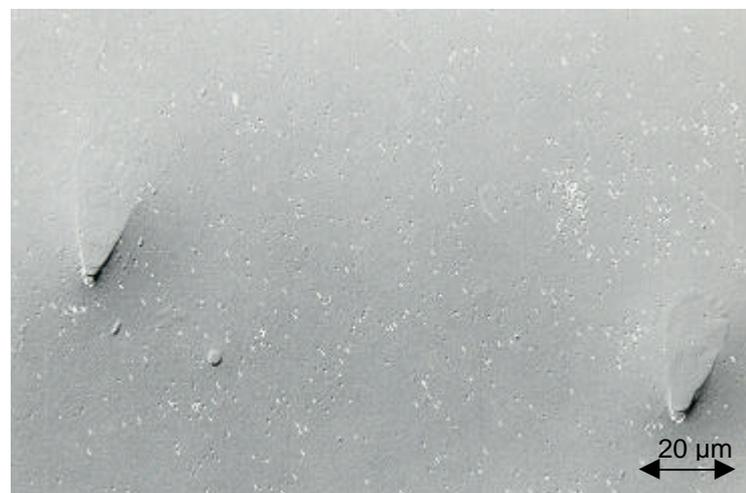
**Abb. 4.4:** REM-Aufnahme der {100}-Oberfläche maskiert durch verstärkte Bildung von Wasserstoffgasen [58].
