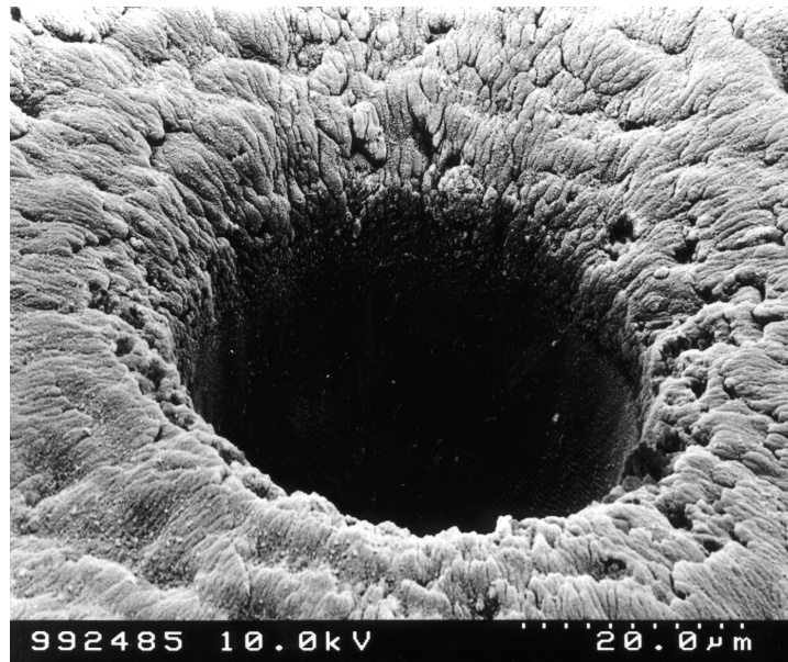
Abbildung 6.13: REM-Aufnahme (30°) der Ultrakurzpuls-Ablation von AlN mit 500 zirkular polarisierten Laserpulsen an Luft unter Atmosphärendruck ( \lambda = 800 \text{ nm} , \tau = 130 \text{ fs} , 10 \text{ Hz} , \Phi_0 = 7.7 \text{ J/cm}^2 ).
