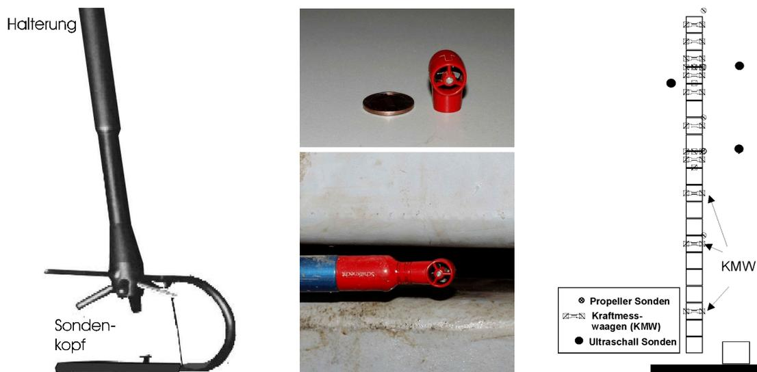
Abb. 3.5: Ultraschallsonde und Propellerkopf zur Geschwindigkeitsmessung
