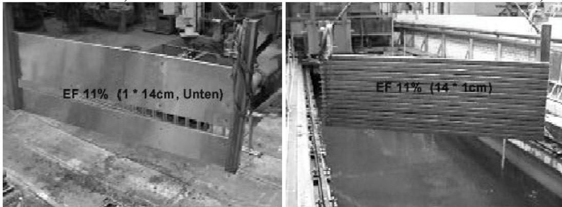
Abb. 4.9: Versuche im Wellenkanal der TU Berlin (MWK) – Porosität im Mittel 11%
