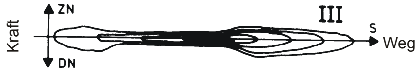
Bild 3.2: nichtlineare Kraft-Wegkennlinien eines Fahrersitzdämpfers nach [15]
