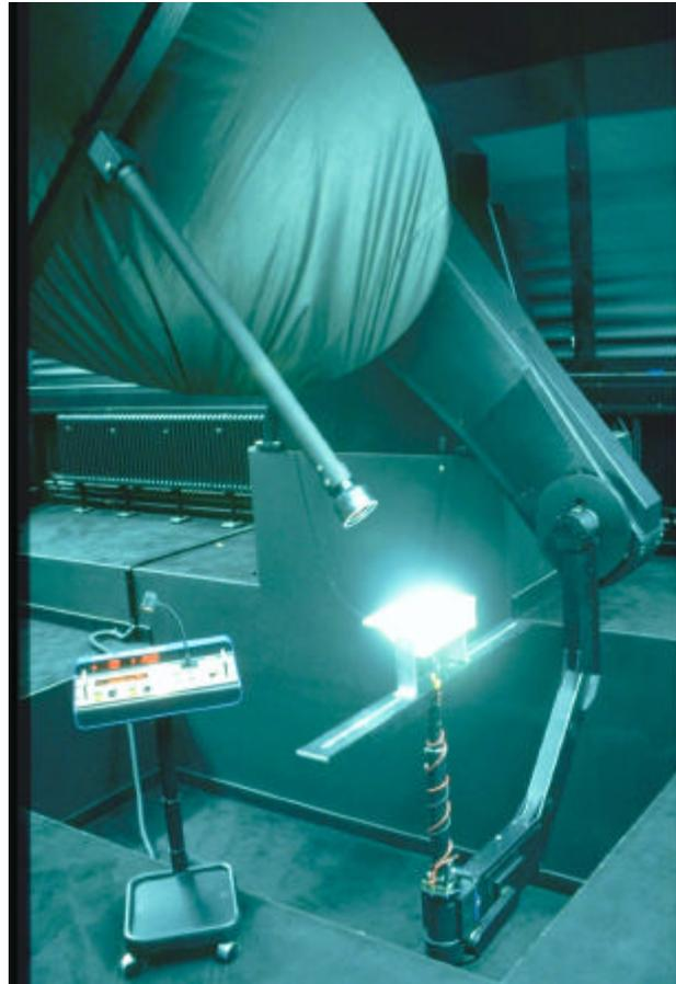
Bild 11: Meßaufbau zur Nahfeldphotometrie am Drehspeigelgoniophotometer
