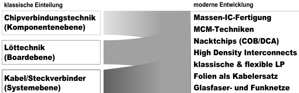
Abb. E.1: Angleichung der Verbindungstechniken durch Miniaturisierung.
