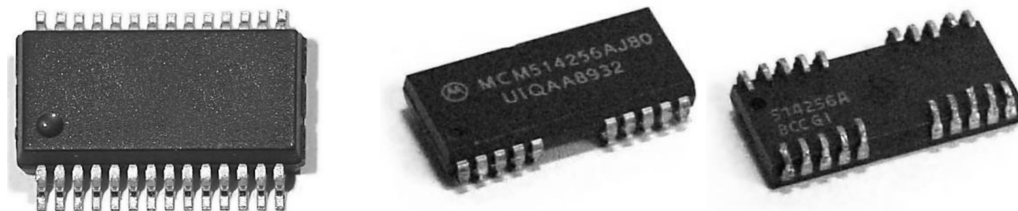
Abb. E.11: SO-Gehäuse (mit Gullwing-Anschlüssen, hier SSO28) und SOJ (Ober- und Unterseite eines SOJ20-16).
