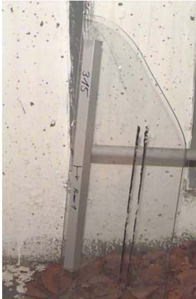
Abbildung 4.18: Die Fotografie zeigt den Umwelttest für die Verklebung Glas – Metall nach etwa 20 Monaten. Die schwarzen Reststreifen auf der rechten Seite stammen von einem Kleber, der die Bedingungen unter freiem Himmel nicht überstanden hat, der Kleber links („Dynaflux 22“ der Fa. Roda Chemie, Berlin) hält weiterhin ein Aluminium U-Profil an der Scheibe.
