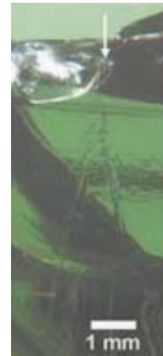
Abbildung 2.9: Die linke, mikroskopische Aufnahme zeigt eine 10 mm dicke Glasbruchkante. Es sind in verschiedene Richtungen ins Glas laufende Mikrorisse erkennbar, z. T. bis 3 mm lang. Sie beginnen an Inertialbrüchen mit einigen zehntel Millimetern Länge, die sich im Laufe der Zeit bzw. durch weitere Druckeinwirkung vergrößern. Auf der rechten Seite ist ein durch ein stark lokalisiertes Druckereignis erzeugter Riss zu erkennen.
