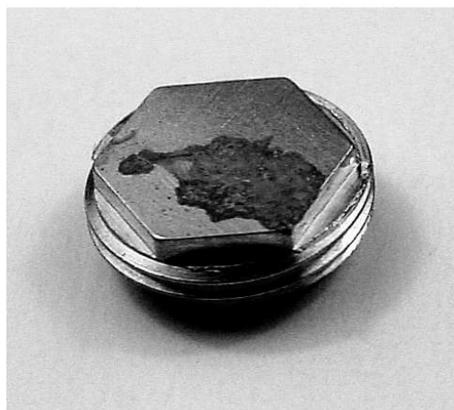
Abb. 4.1.3.4: Foto des Bodens einer defekten DSC-Kapsel
