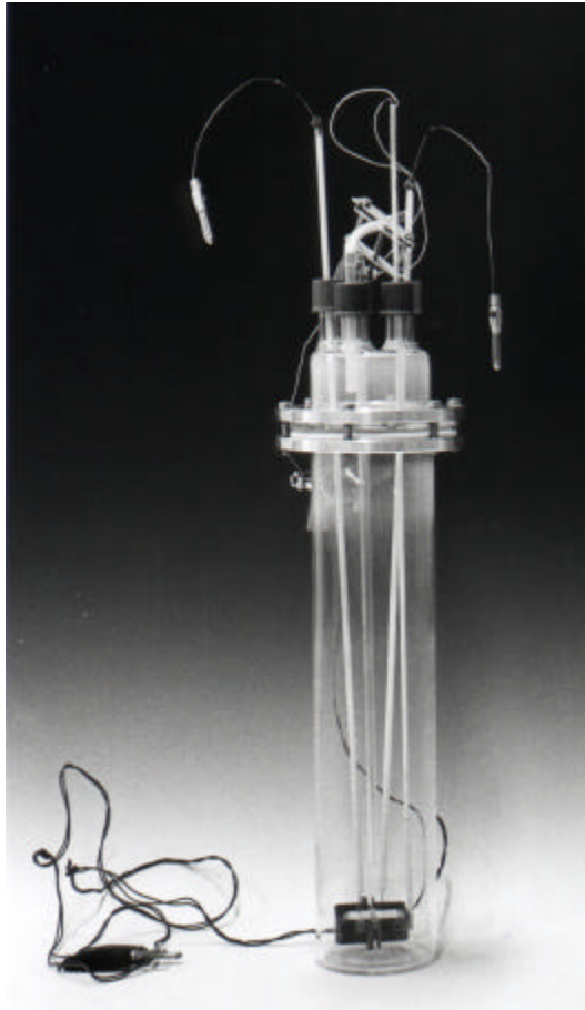
Abb. 64: Quarzglascontainer mit Zelle
