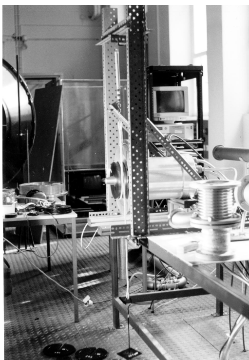
(a) Motor- und Frequenzumrichter-Kennlinienmessung mit Hilfe einer Bremstrommel (statt des Laufrades), eines Seiles, einer Federkraftwaage und diversen Gewichten
