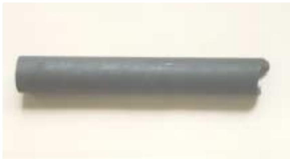
Bild 29: SiC-Rohr nach dem Tauchversuch
