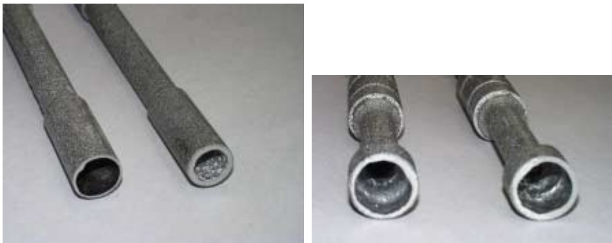
Bild 72: Unterschiedliche Randschichtdicken bei Zugstäben
