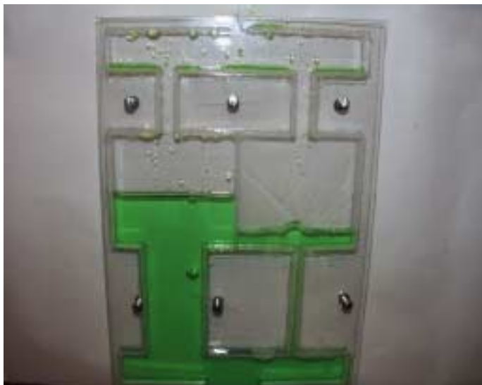
Bild 62: Formfüllung der Testgeometrie im Laborversuch (Druckanstiegszeit t = 30 s)
