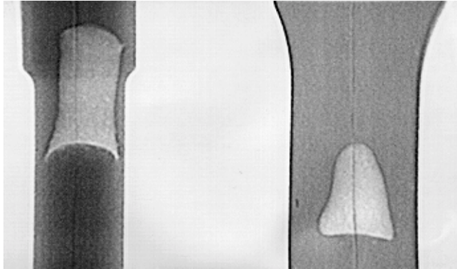
Bild 49: Gußfehler in Folge der Formfüllung von oben und unten
