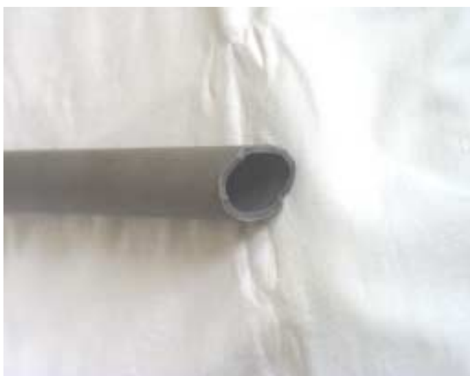
Bild 30: AlN-Rohr nach dem Tauchversuch
