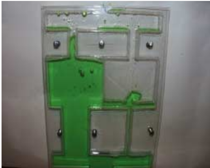
Bild 61: Formfüllung der Testgeometrie im Laborversuch (Druckanstiegszeit t = 10 s)
