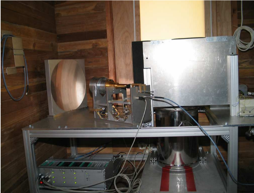
Abbildung 4.10: Das Frontend des WARAM 2: links der fokussierende Spiegel und das Empfangshorn darunter die Stromversorgung und Steuerung, rechts die Halterung für die warme Last und unten der Dewar für den flüssigen Stickstoff
