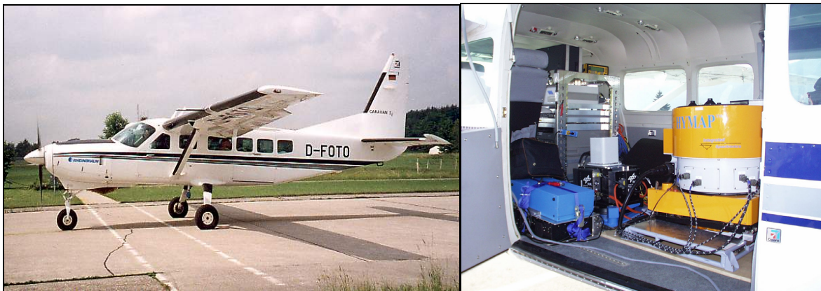
Abbildung 4-9 Cessna 208 CARAVAN (links) und HyMap TM - und HRSC-A eingebaut in der Cessna (rechts) (Quelle: LEHMANN et al. 2000).
