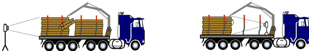
Abbildung 4: links: Fotonahme der Rückseite des hinteren Holzstoßes des Lkws; rechts: Fotonahme der Vorderseite des hinteren Holzstoßes nach Entladung des vorderen Holzstoßes
