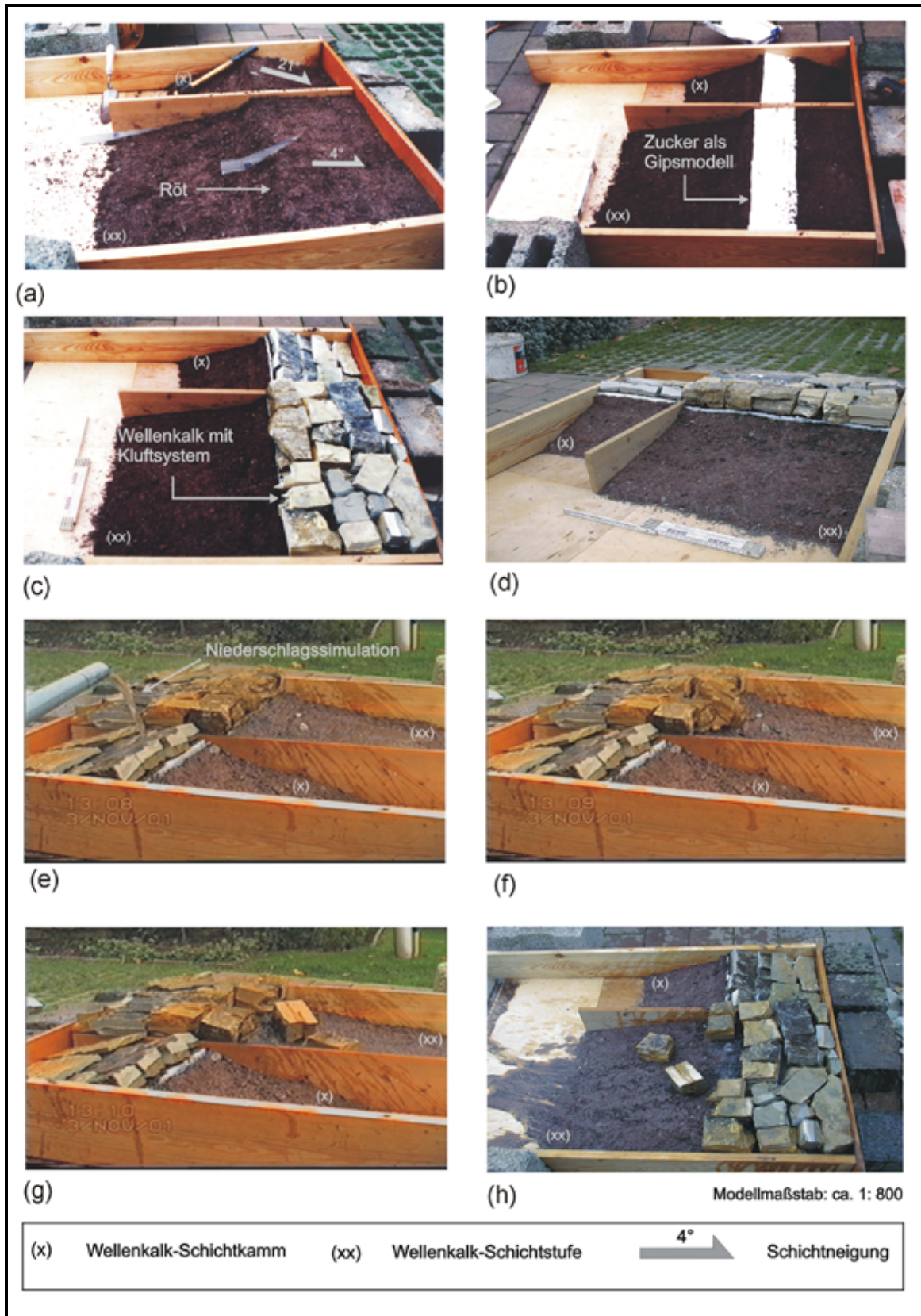
Abb. 5.30: Modellversuch zur unterschiedlichen Massenverlagerungsbeeinflussung an Wellenkalk-Schichtstufen- und Schichtkammhängen in Abhängigkeit von der Schichtneigung
