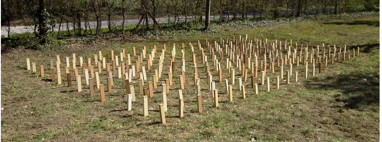
Abb. 3: Prüfkörperanordnung im Erdkontakt am Standort Freiburg
