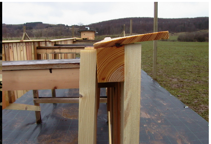
Abb 5: Prüfkörper mit und ohne konstruktiven Hirnholzschutz
