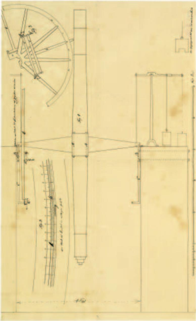
Abb. 44 Repsolds eigenhändige Zeichnung des Meridiankreises (M 1)
