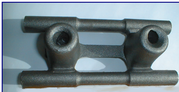
Bild 15: Gußrohling mit Gieß- und Speisersystem für Zugproben
