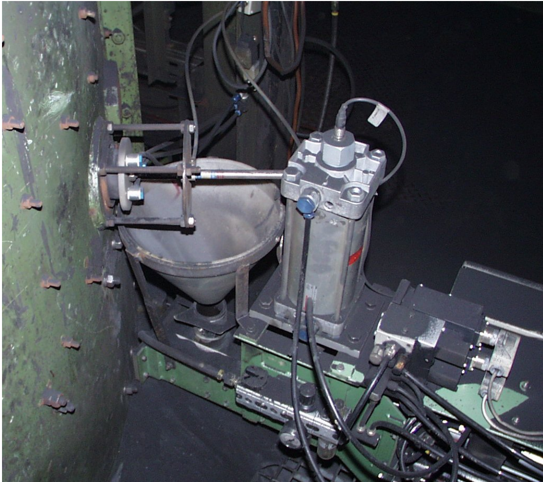
Abb. 108 : Anordnung des Verdichtbarkeitsmessgerätes am Mischer
