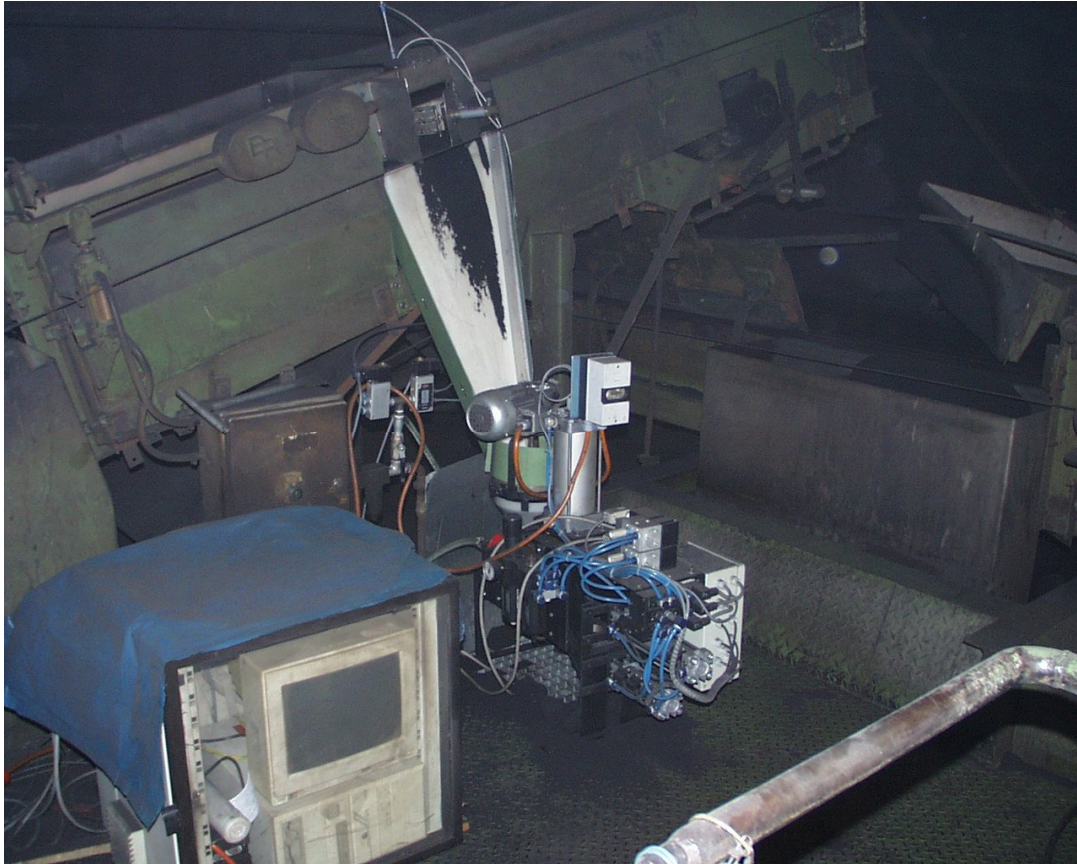
Abb. 112 : Anordnung des Verdichtbarkeitsmessgerätes zur Überwachung des Fertigsands
