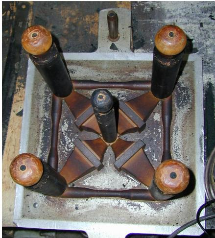
Bild 4.3: Zugstabmodell für den Sandguss
