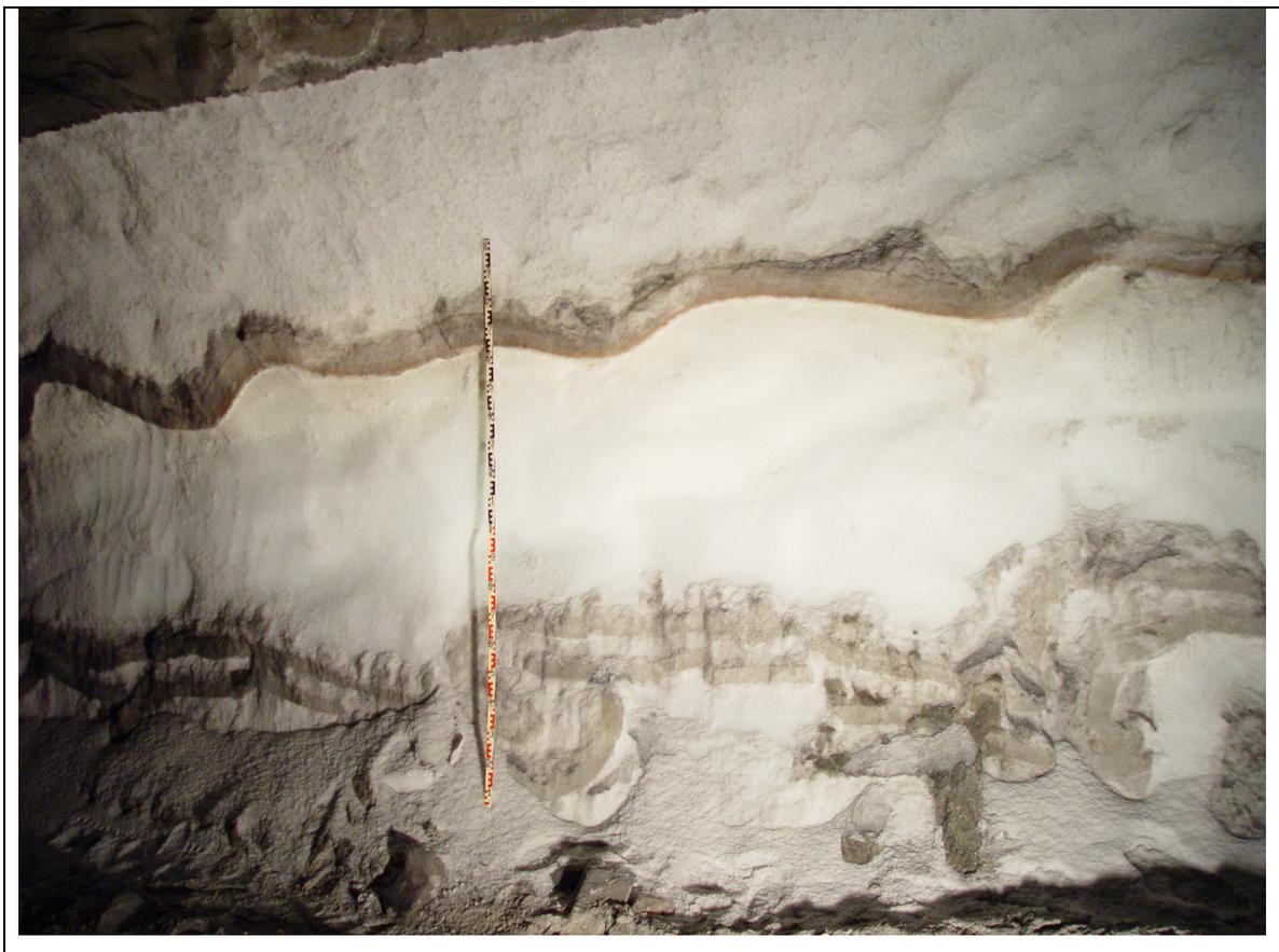
Bild 16: Bänderförmige Ausblühungen von Carnallitit bzw. Kieserit; Örtlichkeit: Zielitz (Foto: A. Hausdorf, 2004)
