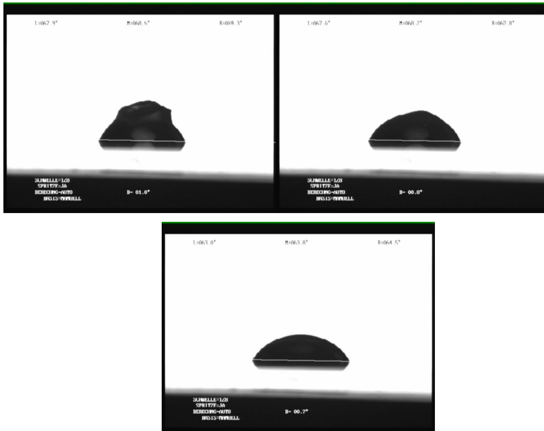
Bild 4.2.9: Tropfenbildung und anschließende Gleichgewichtseinstellung des Randwinkels von PO-Hotmelt während des Schmelzvorganges auf methyliertem Glas (Oberflächenenergie der Oberfläche ist 25,5 \text{ mJ/m}^2 , Messtemperatur 170^\circ \text{ C} )
