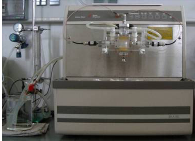
Bild 3.2.10: Aufnahme vom EKA der Anton Paar KG Graz mit von IPF Dresden modifizierter Meßzelle
