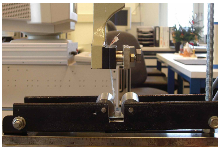
Bild 3.2.17: 90°-Schälprüfung mittels der Walzen-Schälvorrichtung des IPF Dresden
