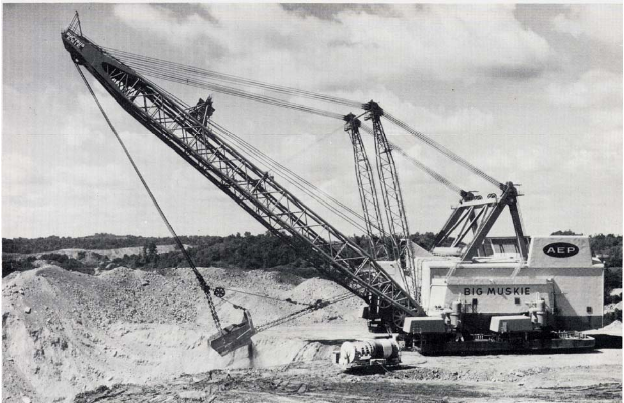
Anlage 4.14 Bucyrus-Erie 4250-W „Big-Muskie“ mit Hydraulik Schreitwerk [84]
