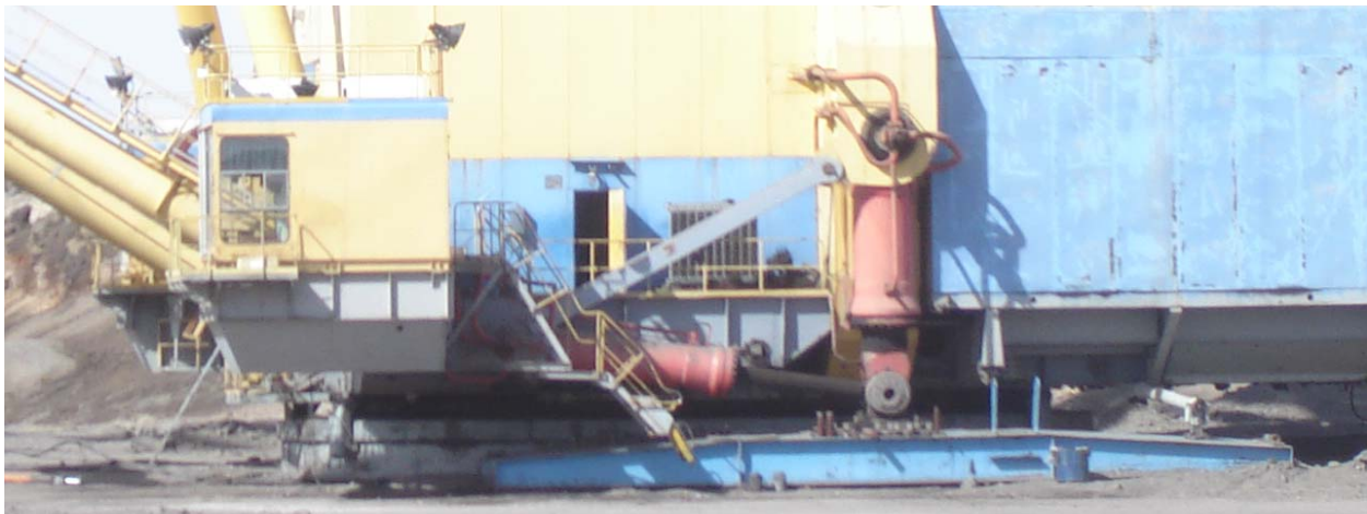
Abb. 4.9 Hydraulik Schreitwerk des Schürfkübelbaggers Esch-25/90 [94]
