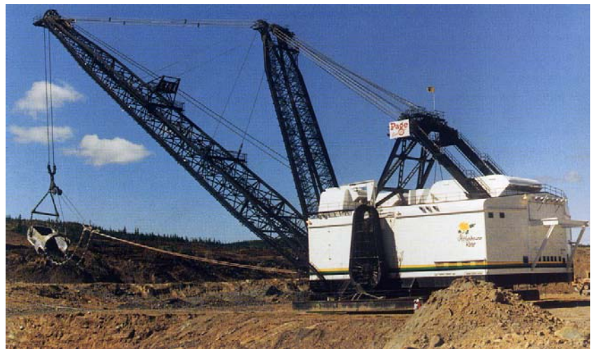
Abb. 4.8 Page Schreitwerk und Schürfkübelbagger mit Page Schreitwerk
