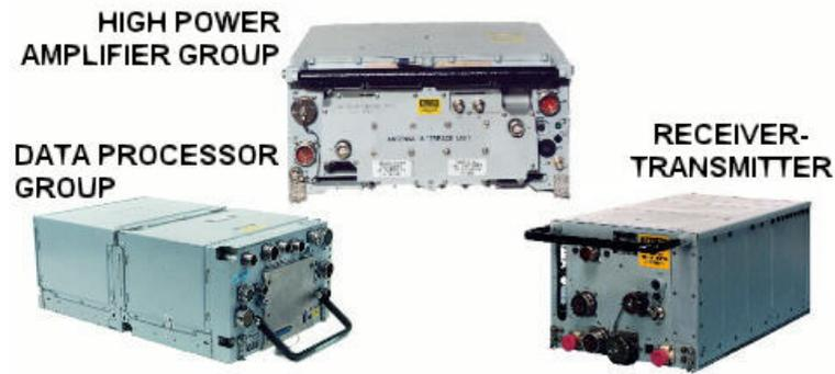
Abbildung 3.4: Elemente eines Class 2 Terminals [13]
