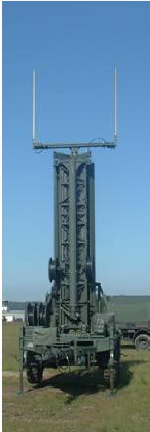
Abbildung 10.12: Antennenanlage für TETRAPOL auf Basis eines AUTOKO II Kurbelmasten, 25m
