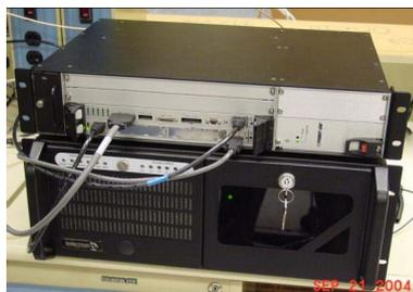
Abbildung 11.6: Platform SDR-3000 (oben) mit Entwicklungsrechner (unten)
