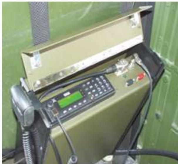
Abbildung 10.8: KFZ - Funkgerät, eingebaut in einen Wolf, ein geländegängiges Fahrzeug
