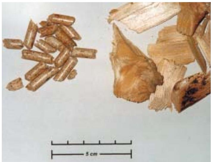
Abb. 3: Pellets (links) und Hackschnitzel (rechts) im Größenvergleich – homogener und kleiner sind Pellets
