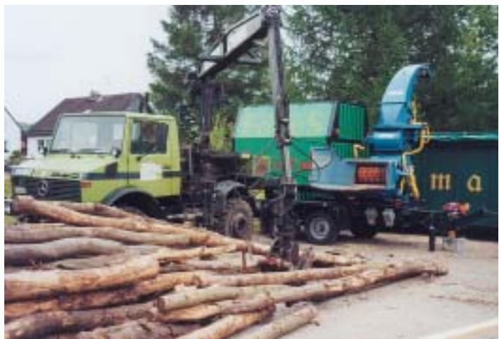
Abb. 1 und 2: Ob mit einem Anbauhacker im Wald oder mit einem Anhängenhacker an einem zentral gelegenen Hackplatz – Logistikvarianten zur Produktion von Hackschnitzeln gibt es viele
