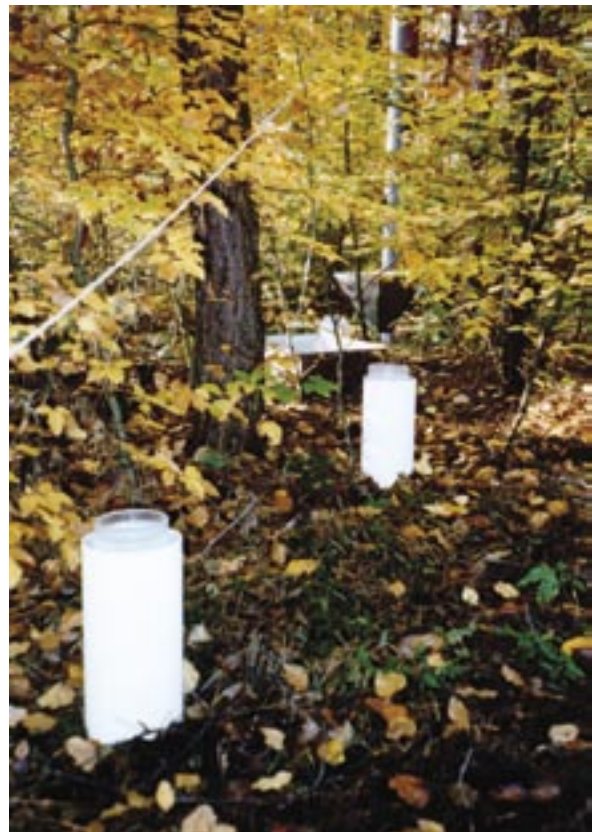
Foto 1: Messung des Unterkronenniederschlags am Waldboden eines Kiefern-Buchen-Mischbestandes
