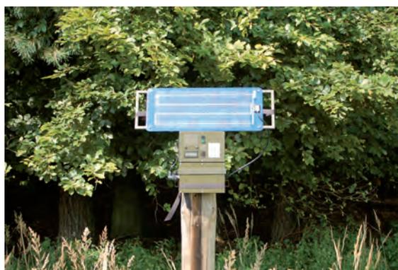
Abb. 4: An einem Waldsaum aufgestelltes Versuchsgerät mit Solarpanel und Bleigel-Akku
