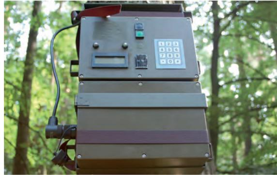
Abb. 1: Der Untersuchungsgegenstand, „Batty“ ein Gerät zur Wildabwehr unter Einsatz von Ultraschalltönen
