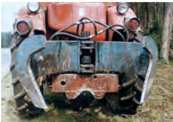
Abb. 305: Entastungskopf RG 140 EA unter der Rückezange am Traktor MTS-52 (Archiv TuT)
