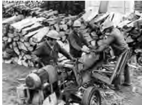
Abb. 324: Spaltmaschine des StfB Schwarzenberg mit Elektroantrieb (Archiv RÖMPLER)
