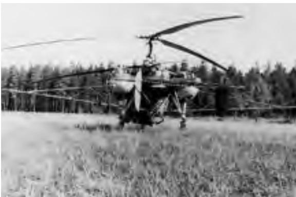
Abb. 249: Hubschrauber KA-26 mit Sprüheinrichtung (HAUSMANN)
