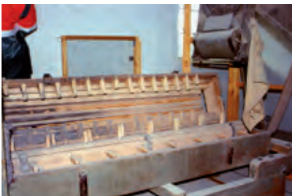
Abb. 73: Große Nockenentflügelungsmaschine mit Magnetabscheider, Darre Jatznick (HAFEMANN)
