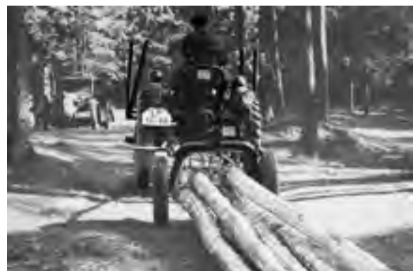
Abb. 405: Geräteträger RS 09 rückt Langrohholz mittels leichter Rückekarre (Archiv BÜTTNER)
