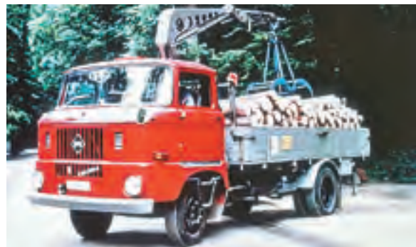
Abb. 477: W 50 Pritschenfahrzeug mit Aufbauadekran (Archiv RÖMPLER)
