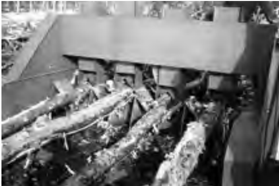
Abb. 297: Versuchsmuster eines „Entastungskammes“ (SCHULZ)
