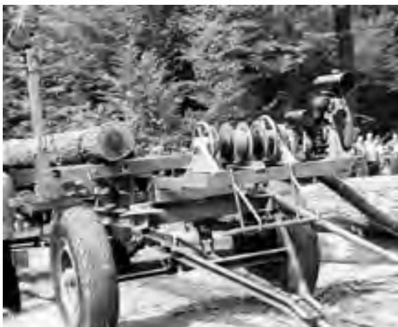
Abb. 469: Motorbeladeseilwinde A 021 am Langholzanhängers (Archiv TuT)
