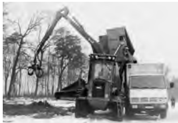
Abb. 332: BRUKS 1000 CT beim Abkippen der Hackschnitzel auf LKW Steyr 91 (Archiv BÜTTNER)
