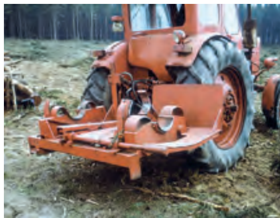
Abb. 303: Entastungsaggregat EA 30 W mit verbesserter Stammführung (BEYER)
