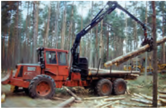
Abb. 446: Forwarder Valmet 882 PK (132 kW; Tragfähigkeit 12-15 t) (Archiv TuT)
