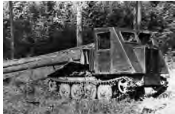
Abb. 443: Kettenrücketraktor TDT-40 (HASCHKE)
