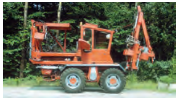
Abb. 386: Entastungs-Paketiermaschine EPAK-4 in Transportstellung (Archiv TuT)
