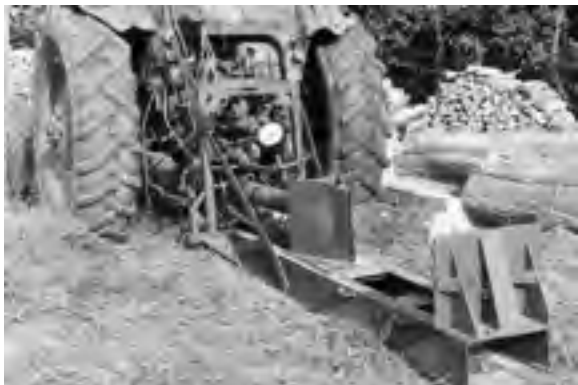
Abb. 322: In Fahrtrichtung am Traktorenheck montierte Spaltmaschine, auch später noch für Nutzscheite und Brennholz benötigt (Archiv ZfP)
