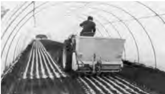
Abb. 134: Sandabdeckung der Reihensaat mit ZUN-7 (Archiv WSD)
