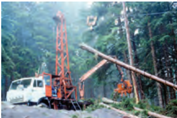
Abb. 343: KP 40 in Kombination mit Kippmastseilkran (HASCHKE)
