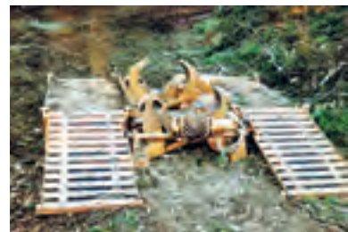
Abb. 309: Zugentastungsaggregate EA 31 mit Druckspeicher und 2 Messerpaaren
