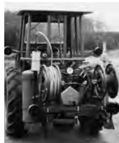
Abb. 204: Pneumatisches Astungssystem „Lübtheen“ (Archiv ZfP)
