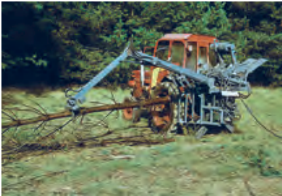
Abb. 366: Entastungsmaschine EA 20 Z 2 im Einsatz (HAUSMANN)
