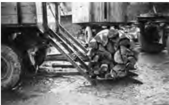
Abb. 465: Beladewippe zum Aufziehen von Schichtholz­bündeln auf den Anhänger mit der Traktoreiseilwinde (Archiv ZILLMANN)
