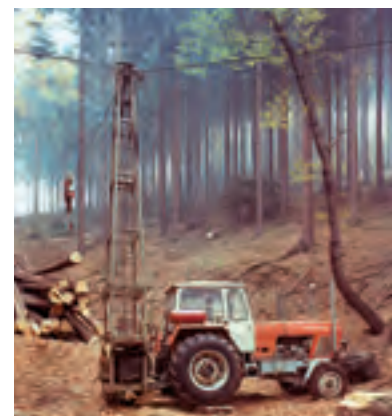
Abb. 457: Kippmastseilkran S 400 Universal bei Bergabförderung (Archiv Oberlichtenau)
