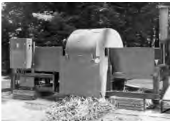
Abb. 580: Schnitz- und Trennautomat Schwarzenberg (Archiv ZfP)
