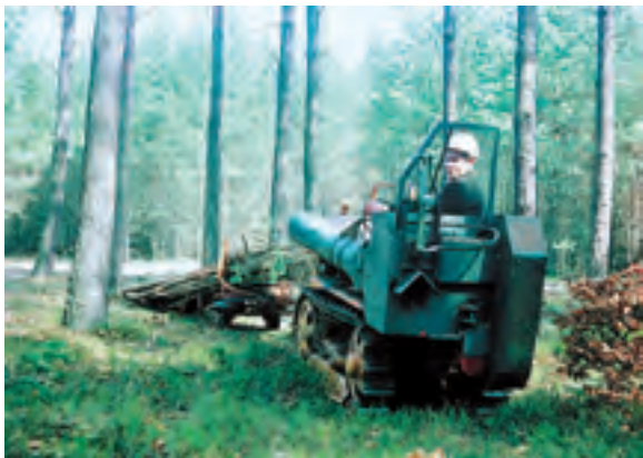
Abb. 363: Kettentraktor Bolgar mit Entastungsmaschine ERM-W beim Rücken der entasteten Stangen (Archiv RÖMPLER)
