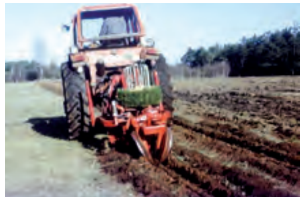
Abb. 217: Pflanzmaschine RPK-S, Var. 1 – leichte Version (KOPP)
