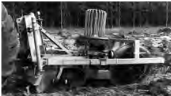
Abb. 218: Pflanzmaschine RPK-S, Var. 2 – schwere Version (KOPP)
