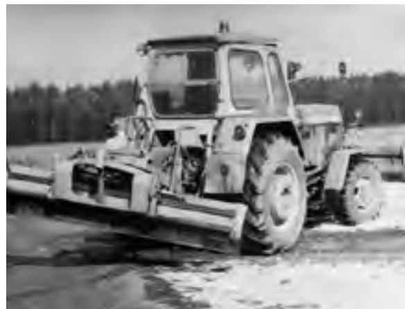
Abb. 521: Anbaugerät zur Wegeinstandsetzung Niesky (Archiv ZfP)
