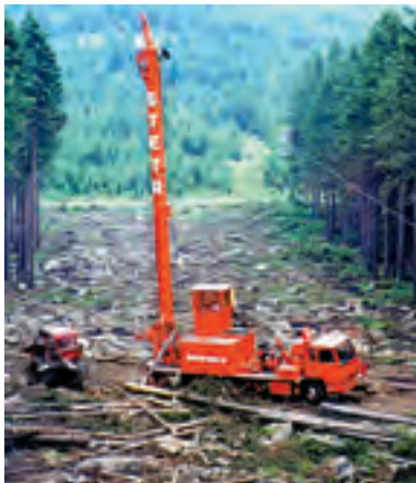
Abb. 454: Förderung mit dem Kippmastseilkran KSK-16 (HAUSMANN)
