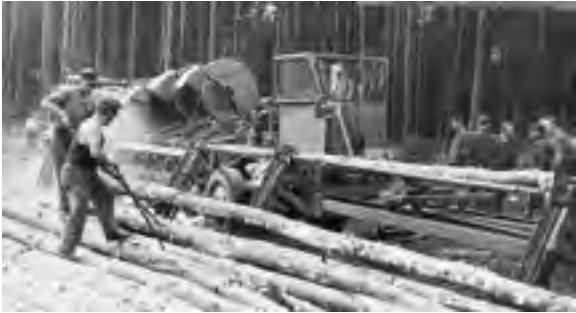
Abb. 289: Mobiles Maschinensystem für Einschnitt und Entrindung Kyritz (HUBE)
