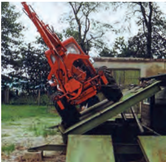
Abb. 15: Rucketraktor DfU 45 auf dem Kippprüfstand (EICHSTEDT)
