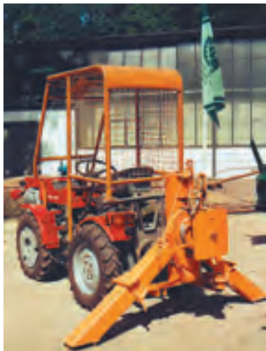
Abb. 378: Zusammenziehen von Stangenbündeln mit Rückeausrüstung RA 20-002 (Archiv TuT)
