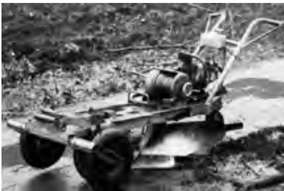
Abb. 234: Unterbaupflug GUP mit Seilwinde (Archiv ZfP)
