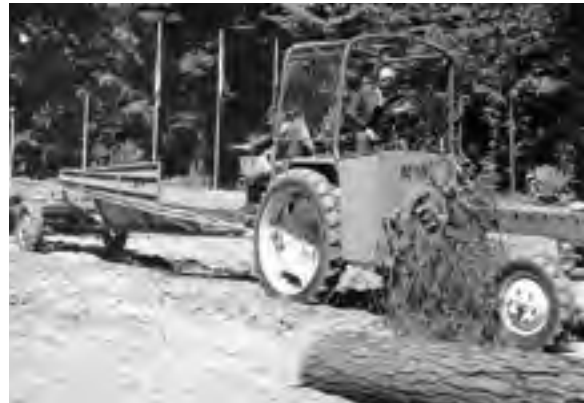
Abb. 364: Geräteträger RS 09 mit Entastungsmaschine IFF-E-02 (Archiv ZfP)
