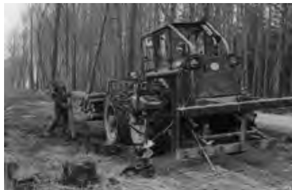
Abb. 228: Setzen von Zaunpfählen mit LKT-75 und Erdlochbohrer (HAUSMANN)
