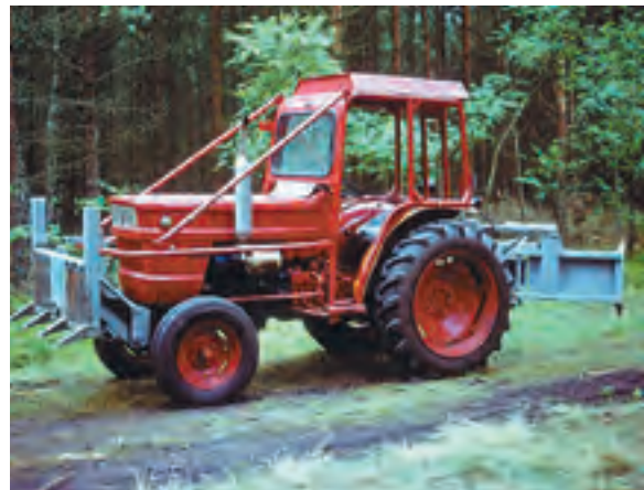
Abb. 372: U 445 V mit hydraulischer Rückezange und Frontpoltereinrichtung (Archiv TuT)
