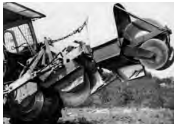
Abb. 207: Pflanzmaschine RPK-S mit Räumerschnecke, Entwicklungsstand 1974 (Archiv RÖMPLER)
