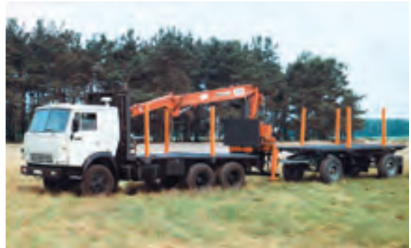
Abb. 509: KamAS/016 mit Rungenaufbauten für Sägeblöcke o. ä. (Archiv Oberlichtenau)
