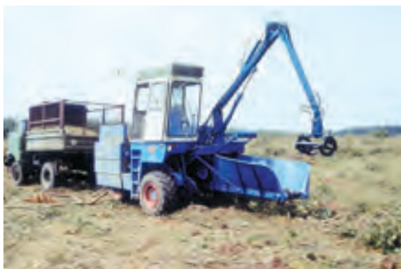
Abb. 337: Exaktfeldhäcksler mit Forstaufbau als Astholzacker E 280 B-FA.1 (BEYER)
