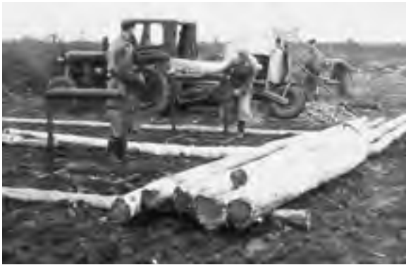
Abb. 316: Entrindung von Grubenholz mit VK 16 am Traktor Ifa-Pionier (Archiv BÜTTNER)
