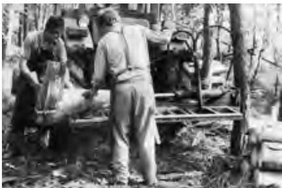
Abb. 321: Quer an der Traktorendreipunkthydraulik angebaute Spaltmaschine des StfB Salzwedel (Archiv ZfP)
