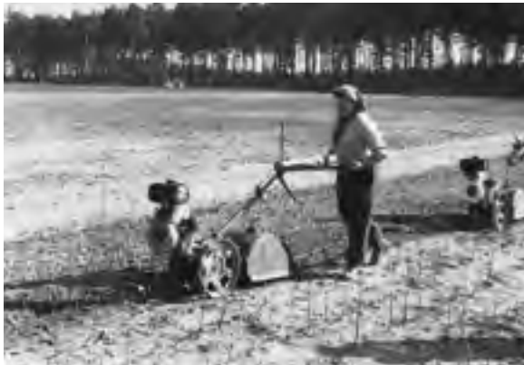
Abb. 83: Maschinelle Pflege einer Verschulung mit Motorfräse 20 (Archiv ZILLMANN)
