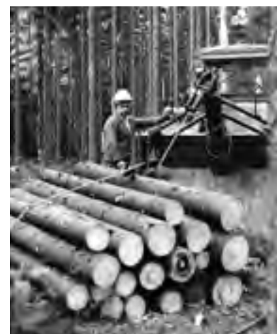
Abb. 430: Traktor MTS mit Rückeausrüstung RA 40 rückt Schichtholz 1980 (Archiv RÖMPLER)
