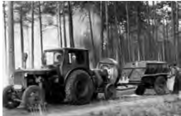
Abb. 169: Kalkblaser S 901 und Kalkvorratswagen S 841 (Archiv RÖMPLER)
