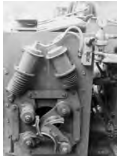
Abb. 318: Der Entrindungsmaschine VK 10 vorgeschalteter Entastungskopf (Archiv ZFP)
