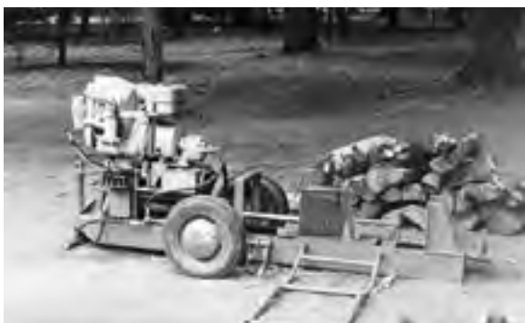
Abb. 323: Spaltmaschine StfB Marienberg-KfL Delitzsch mit Eigenantrieb (TAUCHNITZ)
