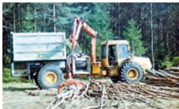
Abb. 336 : Hackmaschine GHM auf Forwarderfahrwerk VKS (SCHULZ)
