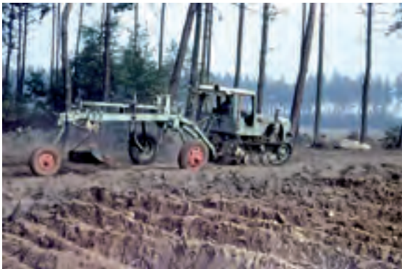
Abb. 167: Vollumbruchpflug B 175 am Kettenschlepper KS 30 (WETZEL)
