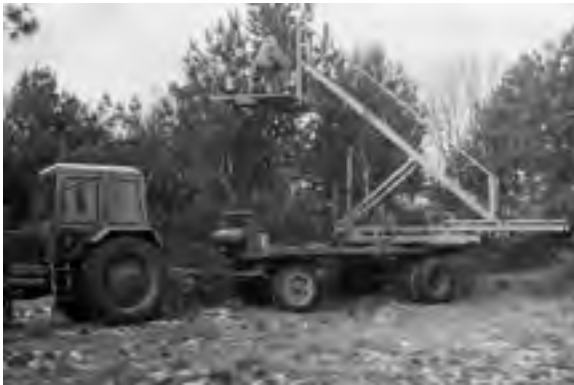
Abb. 65: Arbeitsbühne StFB Rostock (Archiv ZfP)
