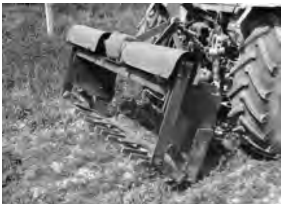
Abb. 108: Beetaushebepflug mit Rütteleinrichtung „Wermsdorf“ (Archiv ZfP)
