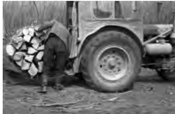
Abb. 428: Anbaurückeschwinge am Traktor RS 01-40 Pionier (Archiv ZILLMANN)
