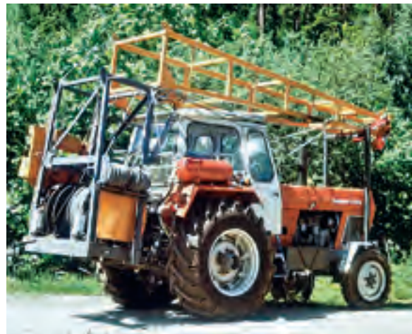
Abb. 456: Kippmastseilrückeanlage S 400 mit Basistraktor ZT 300 1985 (Archiv ZfP)
