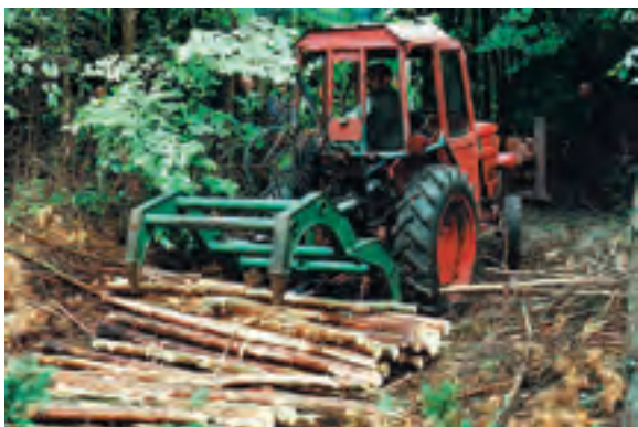
Abb. 390: Angepasste Schichtholzrückegreifer am Standardtraktor U 445 V (Archiv TuT)
