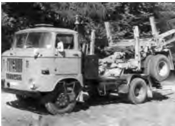
Abb. 480: W 50 L/SH mit Aufbau FA.2 und aufgesatteltem Nachläufer HN 60.58 (Archiv ZfP)
