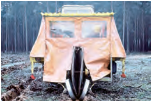
Abb. 206: Pflanzmaschine RPK-V mit Heizung und Beleuchtung (Archiv ZfP)
