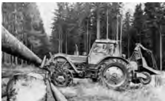
Abb. 417: MTS 82 mit RA 40 poltert Stammholz (Archiv Oberlichtenau)
