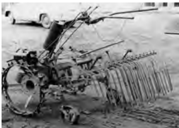
Abb. 86: Fräse Typ 20 mit Ackerbürste (HASCHKE)
