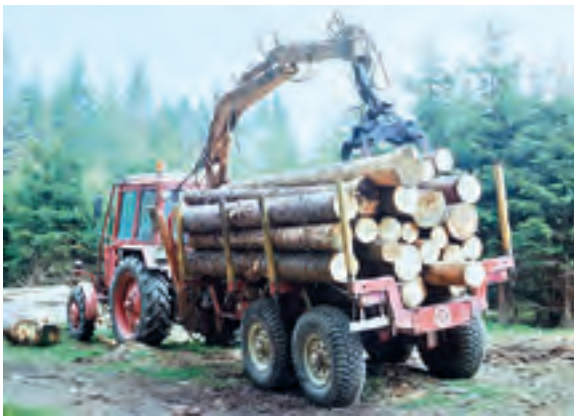
Abb. 432: Polnischer Schichtholz-Rückeanhänger LTPA (8 t) mit Ladekran (Archiv ZfP)
