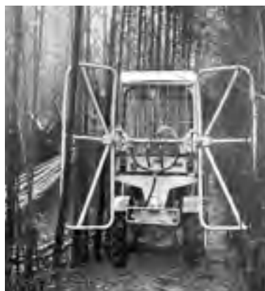
Abb. 361: Vorastungsrahmen am Kleintraktor Tz-4K-14c im Einsatz (Archiv ZfP)
