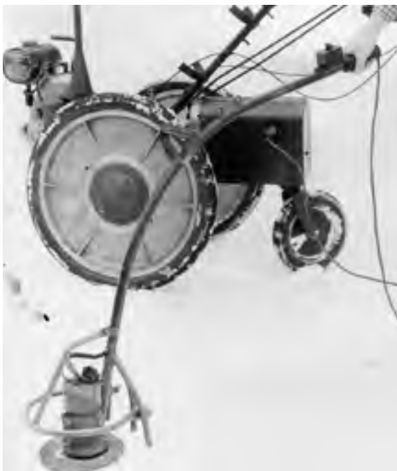
Abb. 84: Einachsschlepper Tharandt mit Generator und Ausgrasgerät (Archiv IFI)
