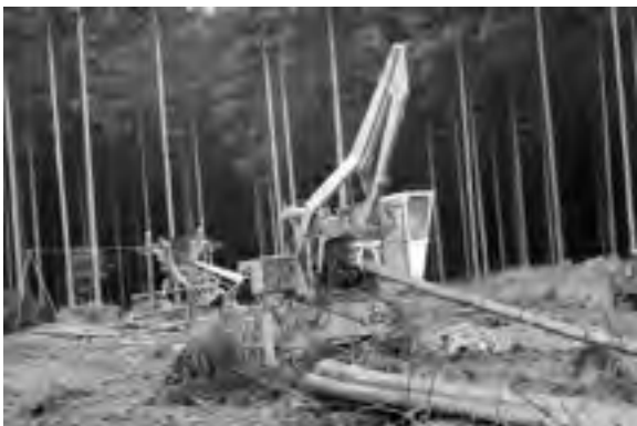
Abb. 298: Rotorentastungsmaschine EA 35 im Einsatz, links die Seilabförderanlage (Archiv ZfP)
