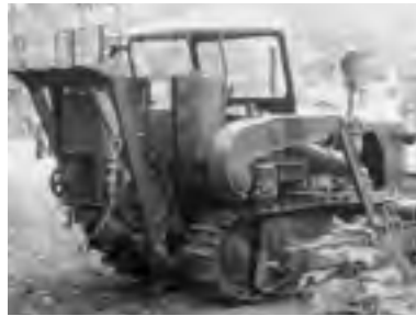
Abb. 407: Kettenschlepper KT 50 mit Seilwinde und Bergstütze (Archiv TuT)
