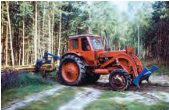
Abb. 425: MTS mit Bündelgreifer für Stangen und Poltergabel 30/87 (TuT)
