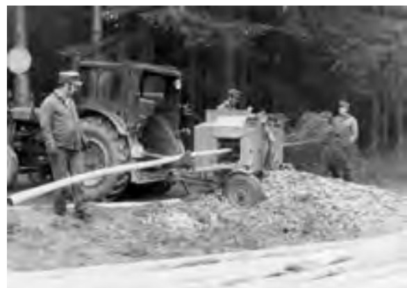
Abb. 319: Kombinierte Entastungs-Entrindungsmaschine VK 10 des StFB Ilmenau im Einsatz, 1973 (Archiv ZFP)
