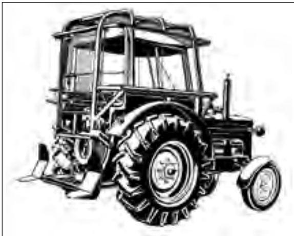
Abb. 411: Traktor Zetor 50 Super mit Rückeausrüstung (HASCHKE)
