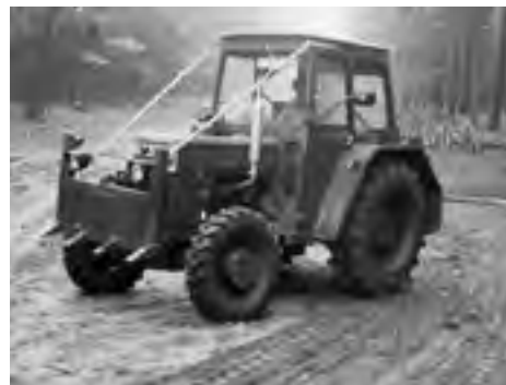
Abb. 371: Standardtraktor U 445 DTC mit Polterschild (Archiv ZfP)
