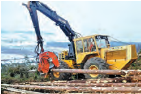
Abb. 342: Kranprozessor KP 40 mit ÖSA-Kran auf LKT 120 (Archiv ZfP)
