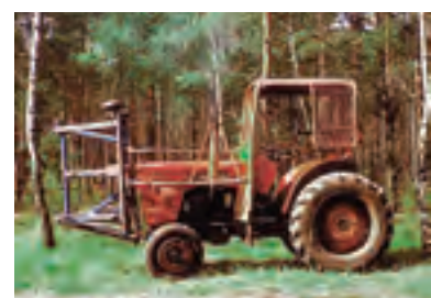
Abb. 362: Vorastungsrahmen am Standardtraktor U 445 V (DRESSL)
