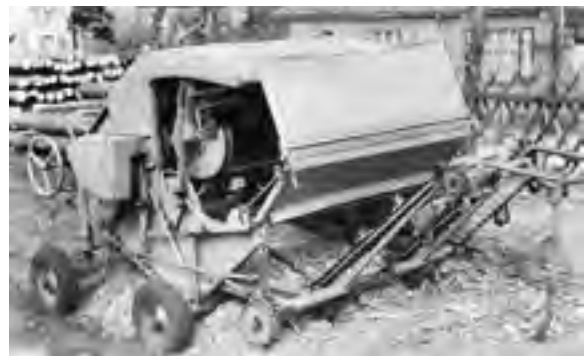
Abb. 314: Entrindungsmaschine ETR 26 „Stüwe“ 1958 (Archiv RÖMPLER)
