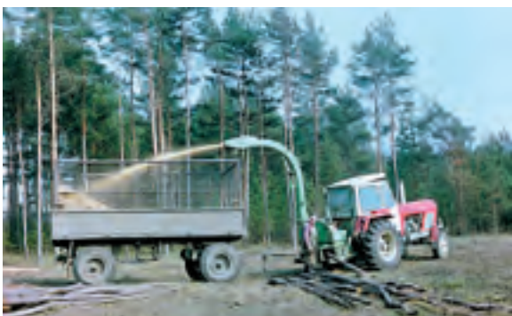
Abb. 326: Anbauscheibenhacker DVCA 100 mit Handbeschickung am Abfuhrplatz (Archiv RÖMPLER)
