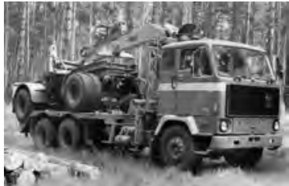
Abb. 500: Volvo F 87 mit aufgesatteltem Nachläufer (Archiv ZfP)
