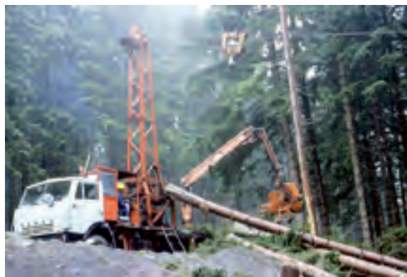
Abb. 47: Kamas-LKW mit Seilkranprozessor S 400/ KP 40 (НАСЧКЕ)
