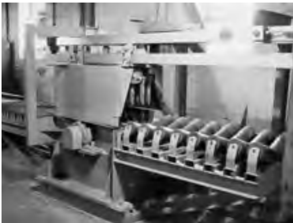
Abb. 582: Mehrblattkreissäge mit hydraulischem Vorschub (Archiv ZfP)
