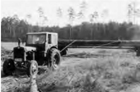
Abb. 468: Beladen eines Langholzanhängers mit Traktor im Querzug (HASCHKE)
