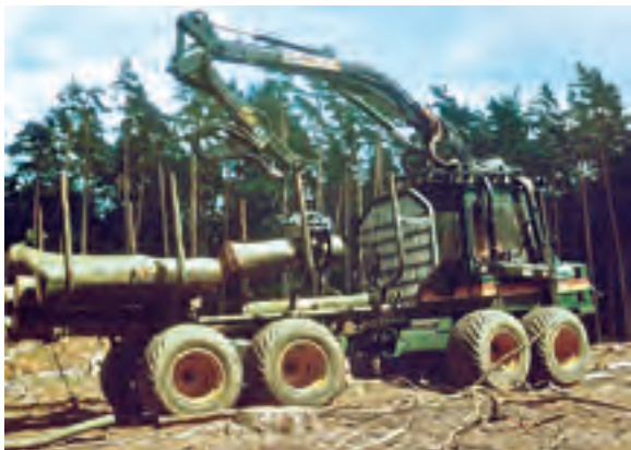
Abb. 447: Forwarder Brunett mini 678 F 1987 (62 kW; Tragfähigkeit 7,5 t) (Archiv ZfP)
