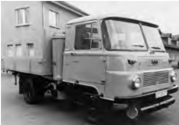
Abb. 507: Holzvergaseranlage auf LKW Robur (Archiv ZfP)
