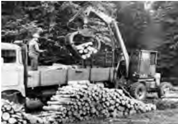
Abb. 490: Mobillader TIH 445 im Einsatz (Archiv RÖMPLER)
