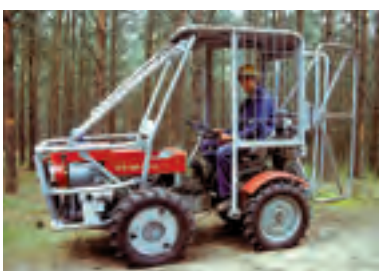
Abb. 360: Vorastungsrahmen am Kleintraktor Tz-4K-14c (Archiv ZfP)
