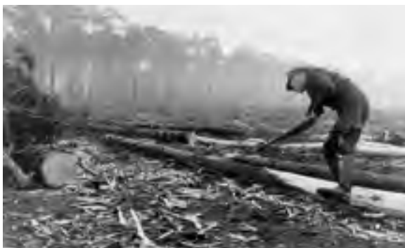
Abb. 264: Entrindung von Kiefernlangholz mit Stoßschälseisen (Archiv BÜTTNER)
