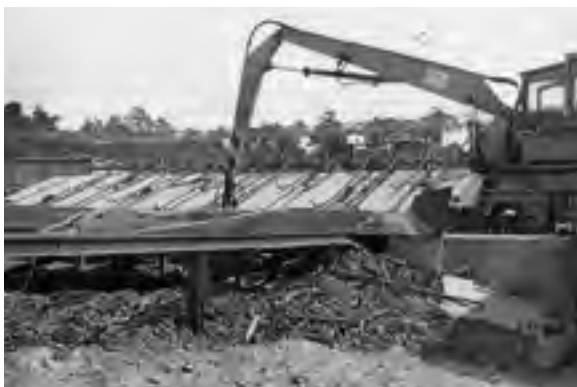
Abb. 549: Mehrblattkreissäge für den Stangeneinschnitt (Archiv BÜTTNER)
