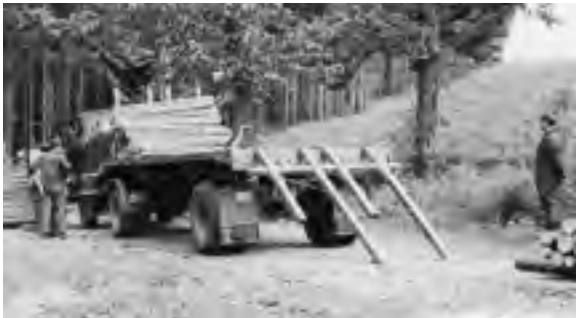
Abb. 487: W 50 mit Plattformaufleger bei der heckseitigen Schichtholzbeladung (Archiv Oberlichtenau)
