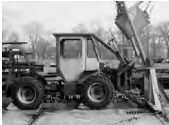
Abb. 21: Prüfstand zum Test der Fahrerkabine des DFU 451 (EICHSTEDT)
