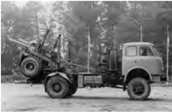
Abb. 497: MAS-509 mit aufgesatteltem Nachläufer HN.80.58 (Archiv RÖMPLER)
