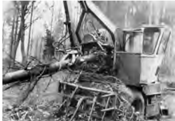
Abb. 299: Entastungsrotor der EA 35, unter dem Rotor der Reisigräumrechen (Archiv RÖMPLER)
