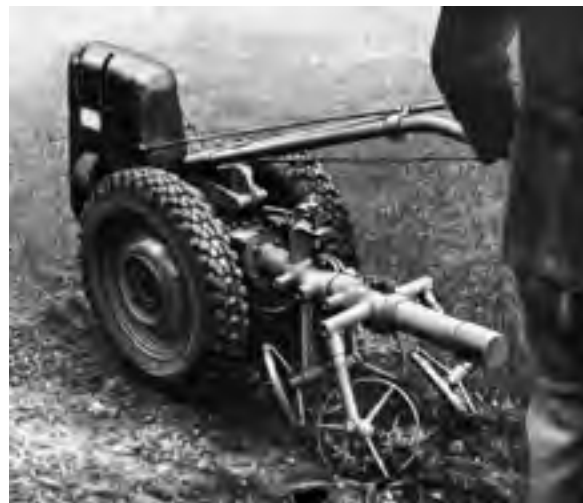
Abb. 191: Galliner Hackgerät am Einachsschlepper (Archiv RÖMPLER)
