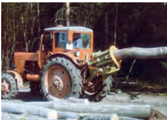
Abb. 421: Rückezange RG 140, als Stapelgreifer eingesetzt (Archiv TuT)
