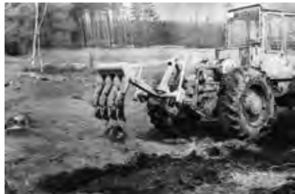
Abb. 226: Plätzweise Bodenbearbeitung mit PAB 88 am LKT-75 (Archiv ZfP)
