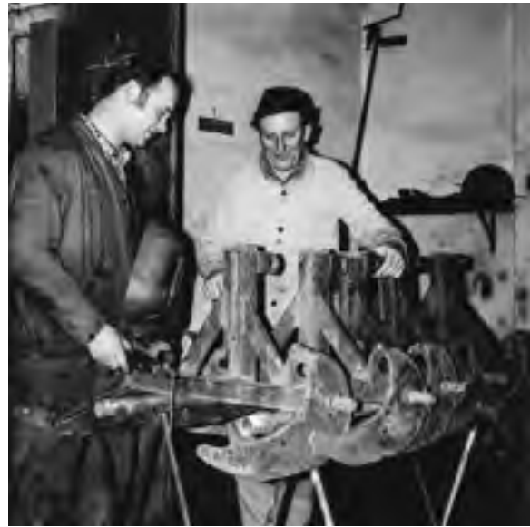
Abb. 41: Fertigung von Rücke- und Polteranbaugeräten für Landwirtschaftstraktoren in Salzwedel (Archiv RÖMPLER)
