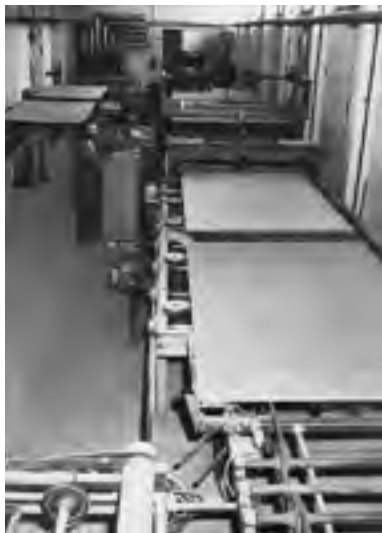
Abb. 583: Wende-vorrichtung im Spanplattenwerk Lunow (Archiv RÖMPLER)
