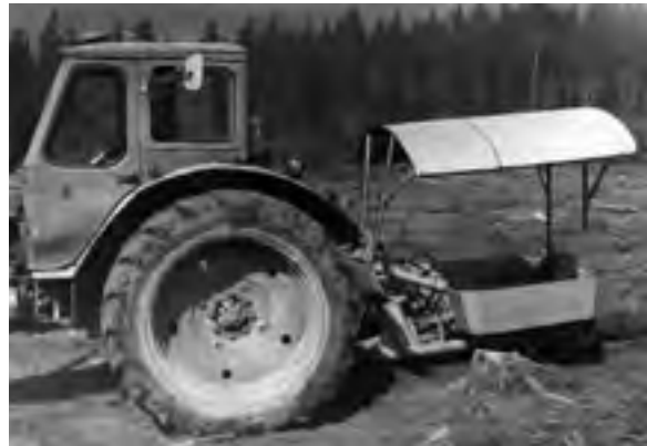
Abb. 212: Pflanzmaschine „Löbau“ (Archiv RÖMPLER)
