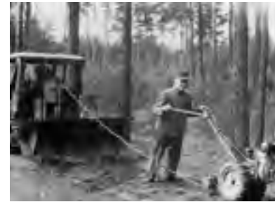
Abb. 408: Leichteres Seilausziehen mit Einachsschlepper (ACHILLES)
