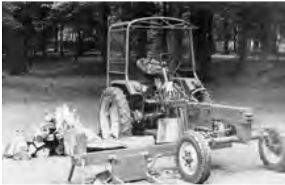
Abb. 320: Schichtholzspalter des MFB Züllsdorf am Geräteträger RS 09 (TAUCHNITZ)
