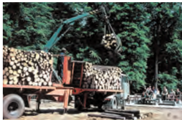
Abb. 493: W-50-Sattelaufleger mit aufgebautem Ladekran T 157 auf der agra (Archiv RÖMPLER)
