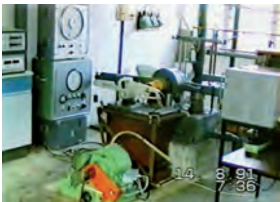
Abb. 24: Leistungsprüfstand für Motorsägen 1968 (SCHADE)
