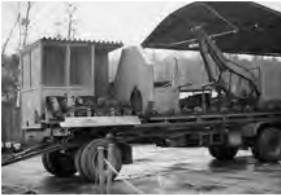
Abb. 292: Mobiles Holzausformungsaggregat Lieberose (Archiv ZfP)
