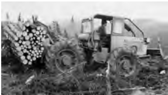
Abb. 437: Schichtholzrückung mit Seilskidder LKT-75 1972 (Archiv ZfP)
