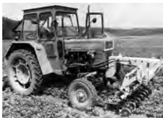
Abb. 95: U 445 L mit Hackausrüstung am Front-Geräteträger (Archiv ZfP)
