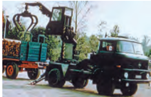
Abb. 492: W 50 mit aufgebautem Kran des Mobilladers T 159 als schnelllaufender Mobillader (SCHULZ)
