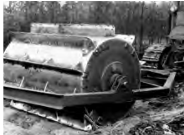
Abb. 152: Brechwalze (Archiv BÜTTNER)
