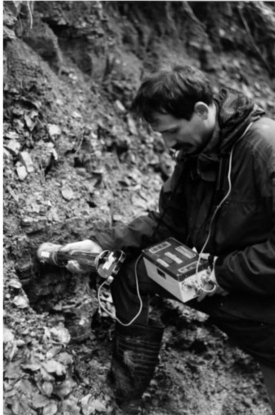
**Abb. 2:** Messung mit der Gamma-Sonde im Gelände.
