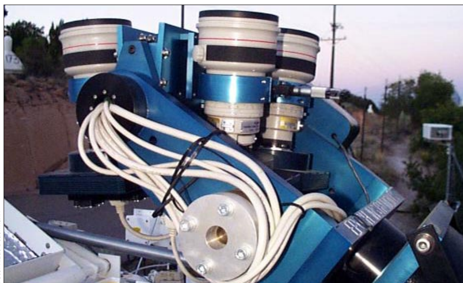
Abb. 2 Das Kleinteleskop ROTSE (Robotic Optical Transient Search Experiment), das innerhalb von Sekunden auf die Position eines satellitendetektierten Blitzes ausgerichtet werden kann.
