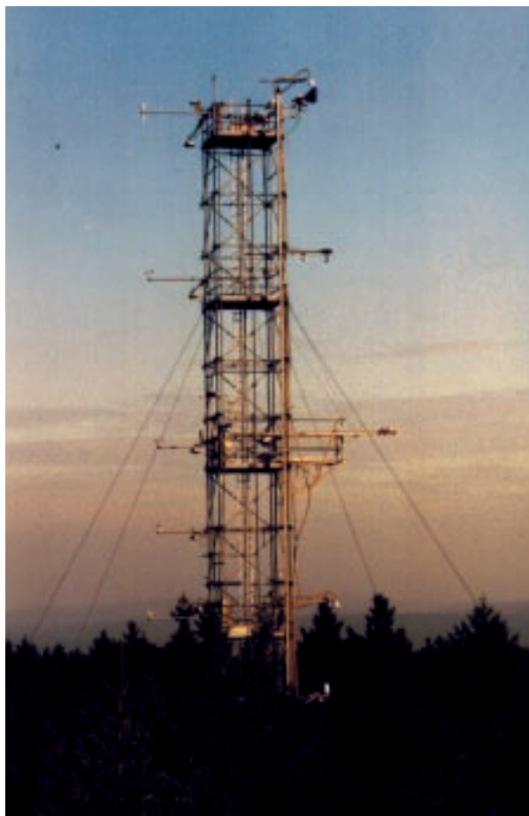
Der 52 m hohe Messturm der Göttinger Bioklimatologen im Solling. Er überragt den Fichtenwald um etwa 20 m.
