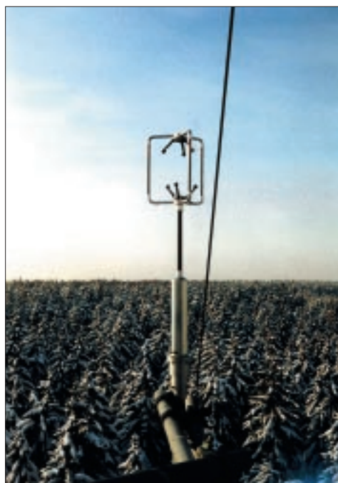
Der Sensor zur simultanen Messung von Luftbewegung und Kohlendioxid-Konzentration. Er ist am Messturm montiert und schwebt etwa 10 m über dem Kronendach des Fichtenwaldes.
