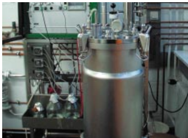
Bis zu 50 Liter Flüssigkeit fasst der Fermenter
