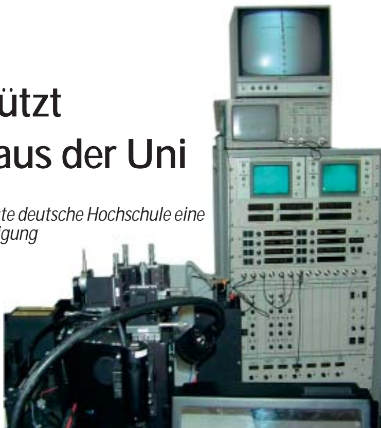
Das technische Kernstück der Selecure GmbH ist das Bakteriensortiergerät.
