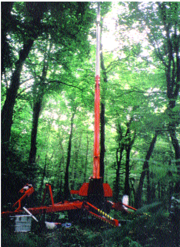
Abb. 3. Hubsteiger mit 30 Meter hoher Kanzel beim Einsatz im Nationalpark Hainich
