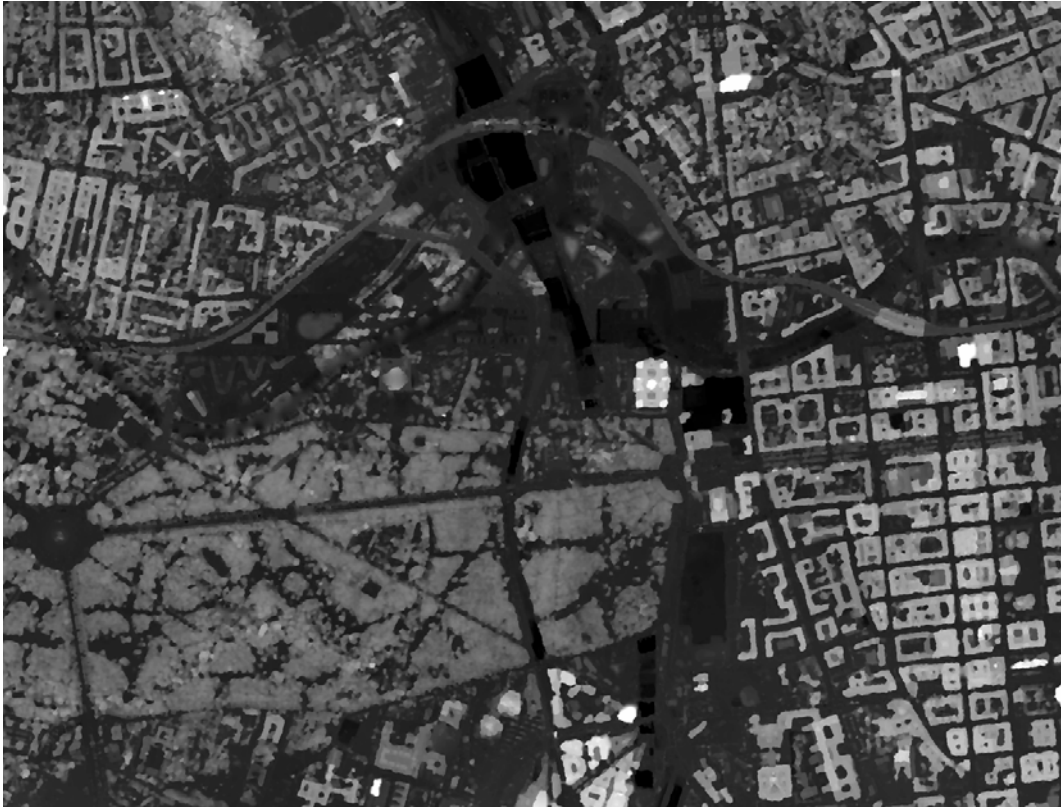
Abb. 15: In Grauwerten kodiertes Digitales Oberflächenmodell, Berlin-Tiergarten
